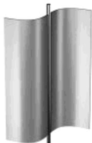
Рис. 4.8. Однолопастной карусельный двигатель
