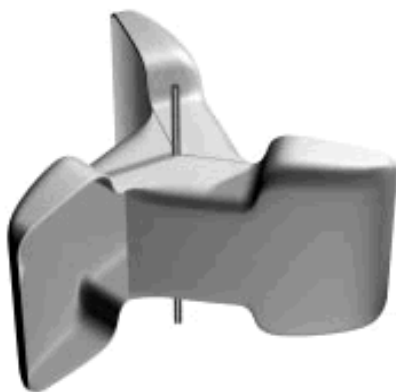
Рис. 4.4. Ветродвигатель карусельного типа
