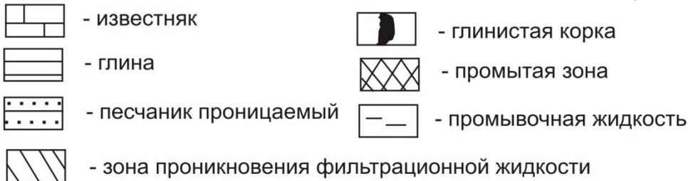
Горные породы обладают различными механическими свойствами. Плотные прочные породы изменяются мало. Поэтому, диаметр скважины в них близок к номинальному (т.е. приблизительно равен диаметру долота). Рыхлые, хрупкие, трещиноватые породы, наоборот, размываются промывочной жидкостью, вследствие чего образуются **каверны**, т.е. увеличивается диаметр ствола скважины.
