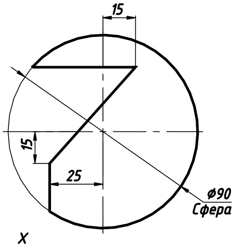
**Задача №2.** Достроить вид слева. На главном изображении выполнить сложный разрез. Нанести размеры. Как вычерчивается контур сечения, если секущая плоскость проходит через ось цилиндрического, конического или шарового отверстия? (10 балл.)
