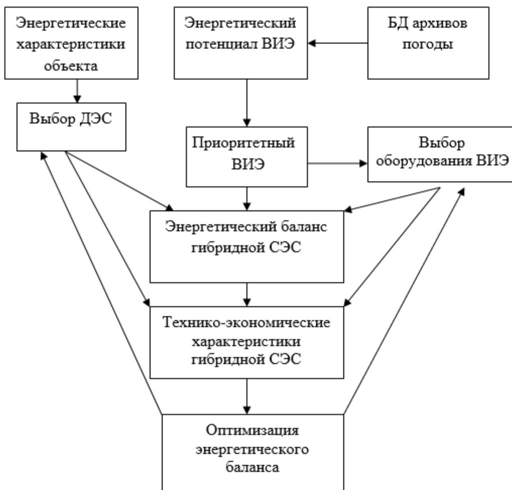
*Рис.51. Структурная схема алгоритма построения гибридного энергокомплекса*
