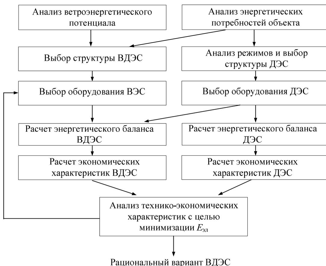
Рис.52. Алгоритм оптимизации ветро-дизельной электростанции
