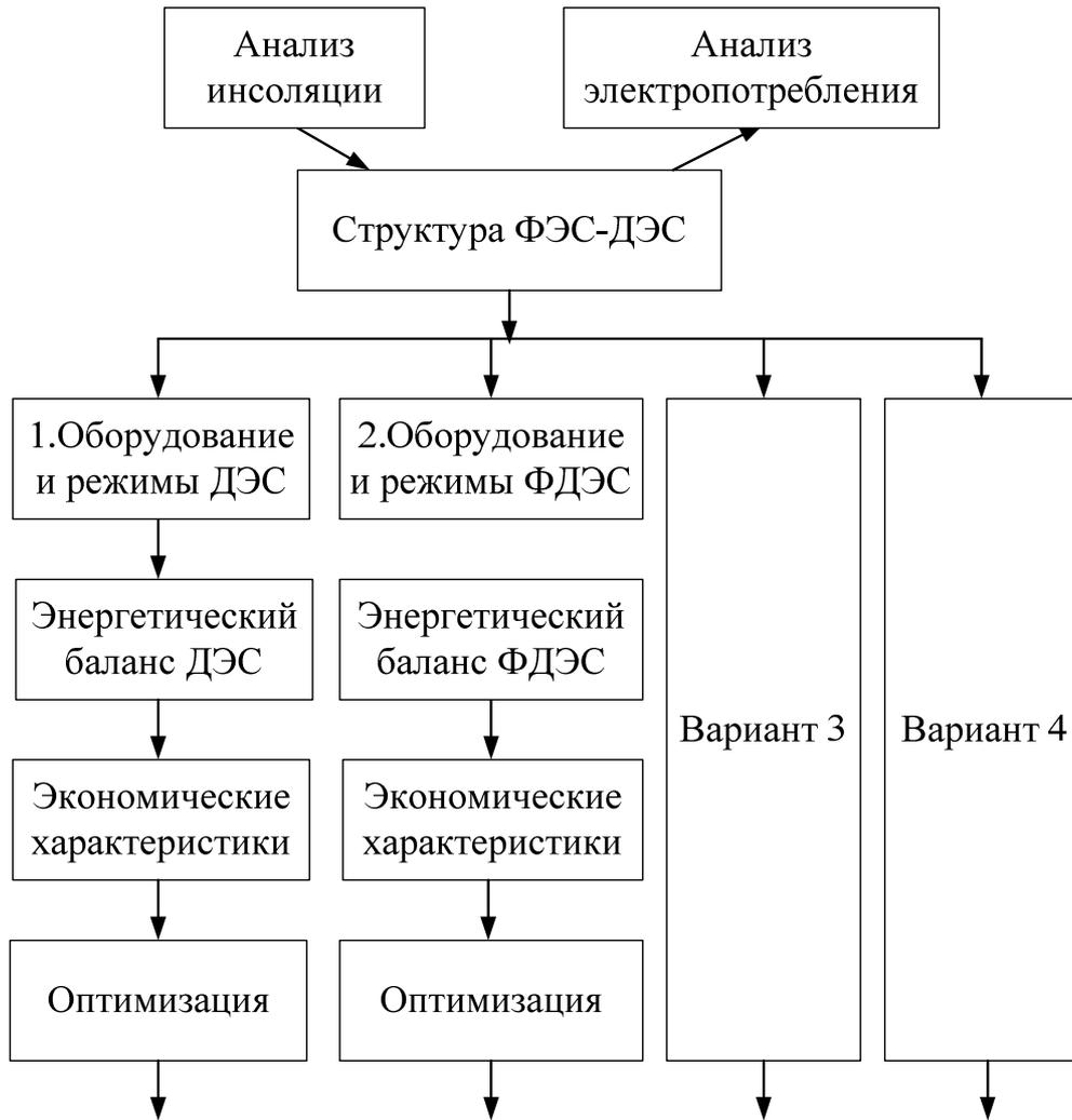
Рис. 53. Оптимизация фото-дизельных систем электроснабжения
