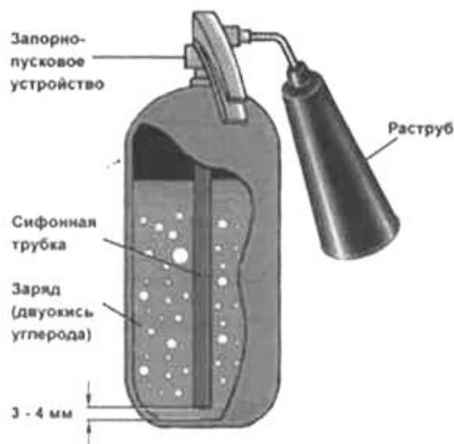
Рис. 2.6. Конструкция углекислотного огнетушителя
