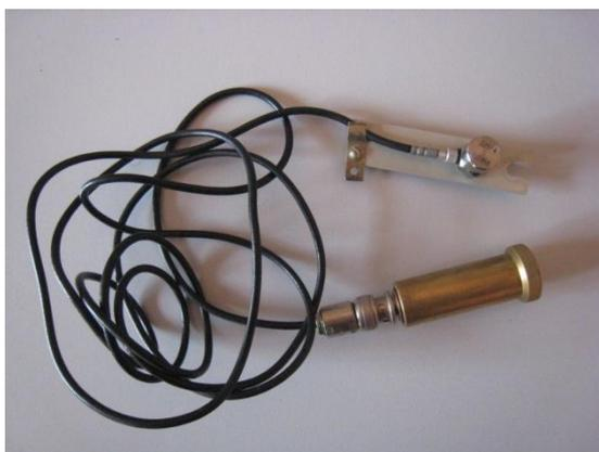
Рис. 7.4. Вибропреобразователь с пластиной, проводом и эквивалентом микрофонного капсуля.
