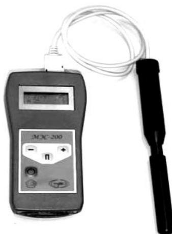
Рис. 4.3 Универсальный метеометр МЭС-200
