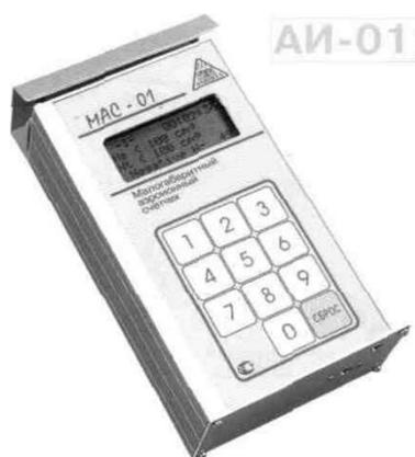
Рис. 4.1. Малогабаритный счетчик аэроионов MAC-01
