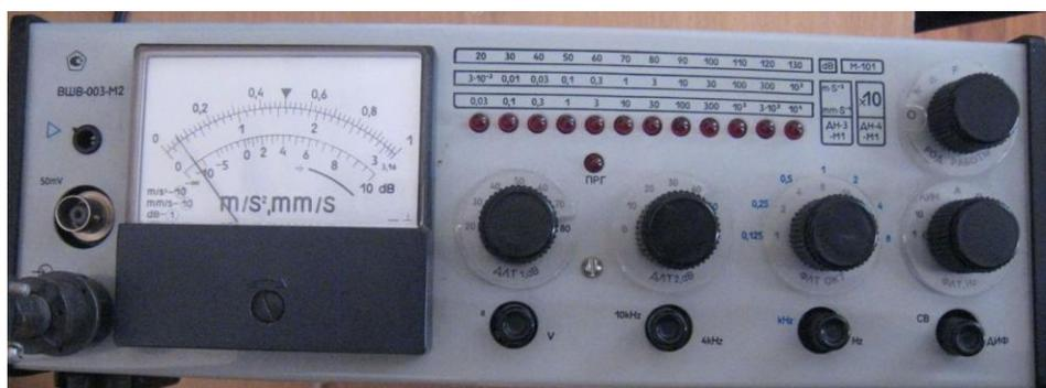
Рис. 7.3. Измеритель шума и вибрации.
