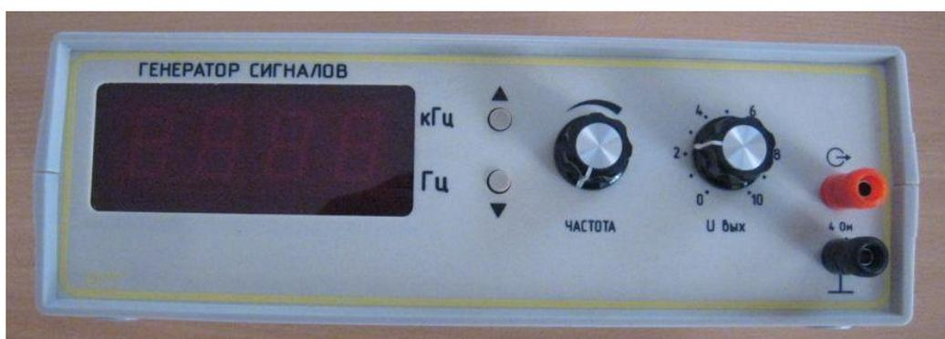
Рис. 6.3. Генератор электрических сигналов
