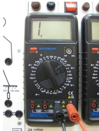
Рис. 9.7. Подключение мультиметра для измерения сопротивления
