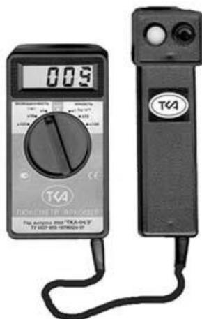
Рис. 4.4. Люксметр-яркометр ТКА-02
