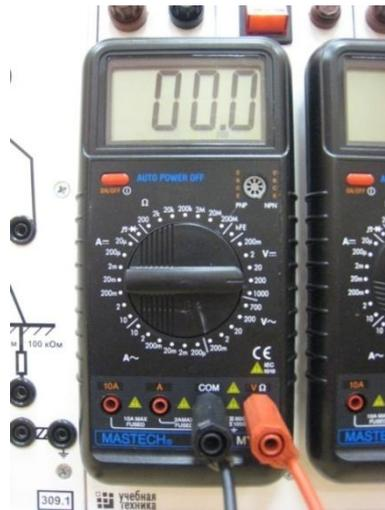
Рис. 9.6. Подключение мультиметра для измерения напряжения
