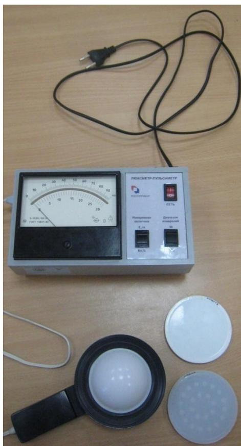
Рис. 5.4. Внешний вид люксметра-пульсаметра
