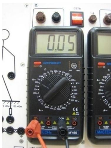
Рис. 8. Подключение мультиметра для измерения тока
