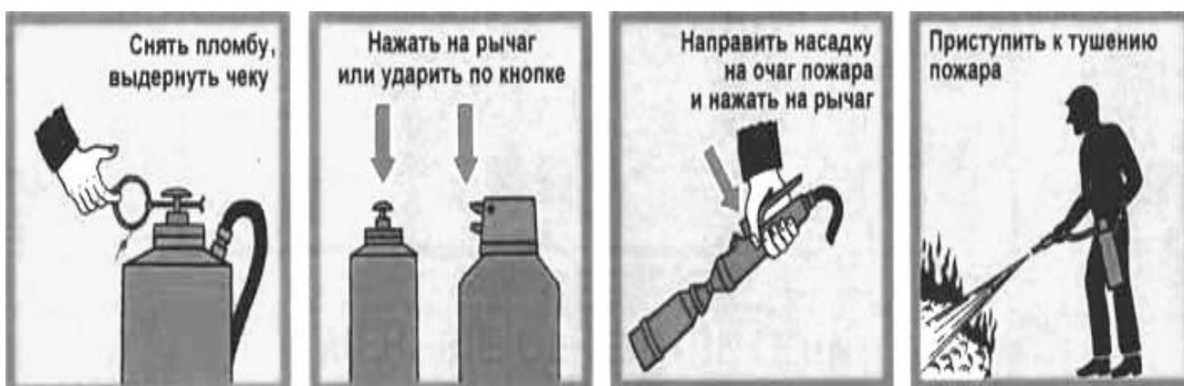
Рис. 2.17. Приведение в действие воздушно-пенного огнетушителя
