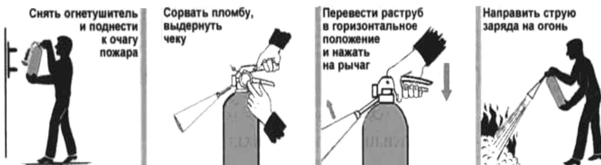
Рис. 2.7. Приведение в действие ручного углекислотного огнетушителя
