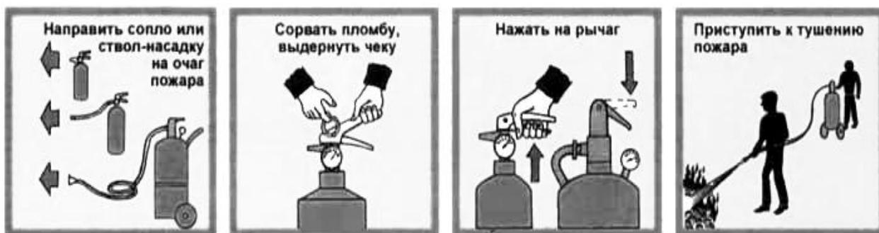
Рис. 2.12. Приведение в действие порошкового огнетушителя закачного
