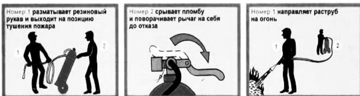
Рис. 2.8. Приведение в действие передвижного углекислотного огнетушителя
