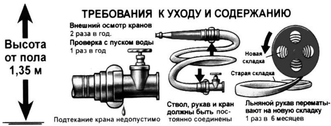
Рис. 2.4. Требования к уходу и содержанию пожарных кранов
