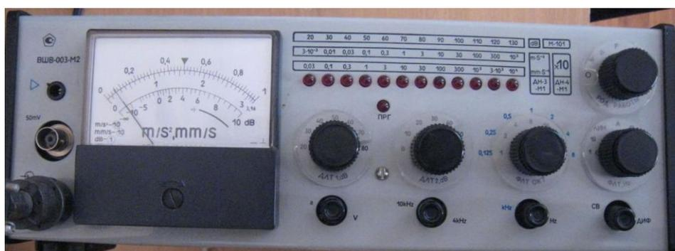
Рис. 6.4. Измеритель шума и вибрации.
