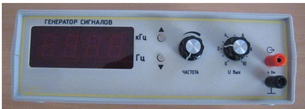
Рис. 7.2. Генератор электрических сигналов
