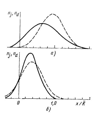
На рисунке 1 — теоретические профили распределения внедренных ионов  $n_j$  (пунктирные линии) и смещенных атомов  $n_d$  (сплошные линии) по глубине при отношении:
