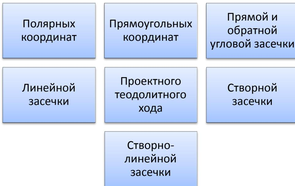
Рис. 6.1. Способы геодезической работы при переносе на местность планового положения точек
