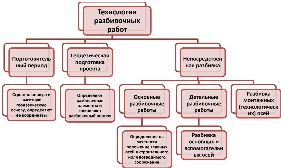
Рис. 4.7. Технология разбивочных работ
