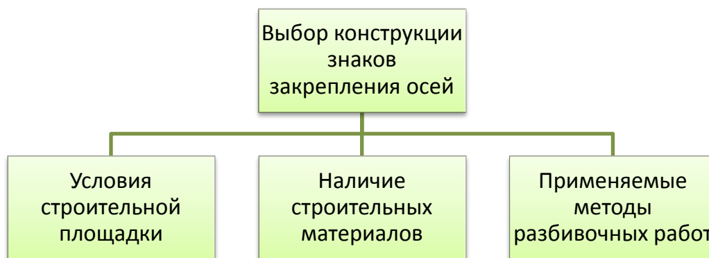
Рис. 7.16. Условия выбора конструкции геодезических знаков
