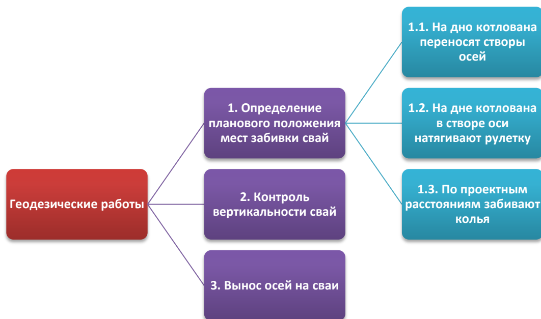
Рис. 7.43. Состав геодезических работ при устройстве свайных фундаментов
