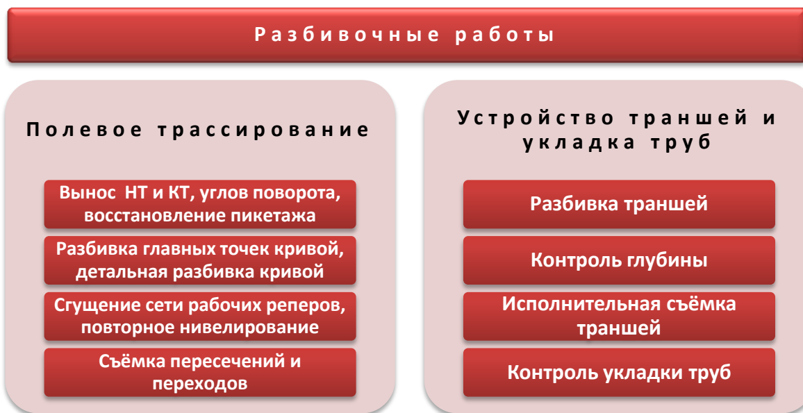
Рис. 7.24. Состав разбивочных работ при полевом трассировании и при прокладке траншей
