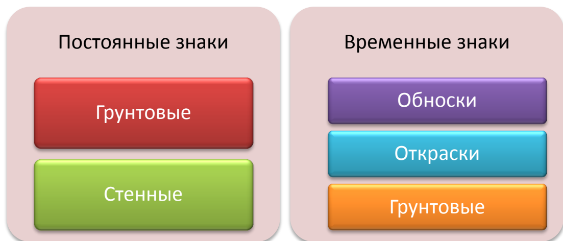
Рис. 7.9. Виды знаков закрепления осей сооружений
