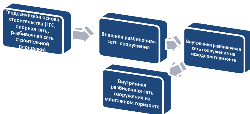
Рис. 7.1. Последовательность построения геодезических сетей (пунктов) на строительной площадке
