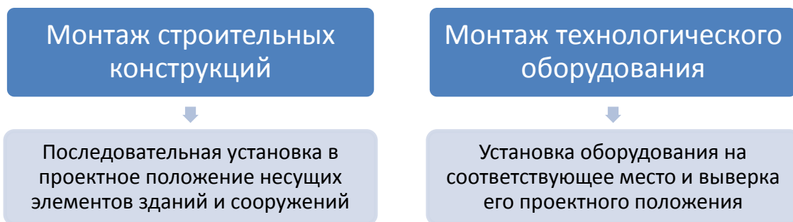
Рис. 8.3. Монтаж строительных конструкций и оборудования
