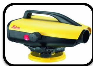
Цифровой нивелир для измерения превышений (Leica sprinter 250m 115605 руб.) [36]
