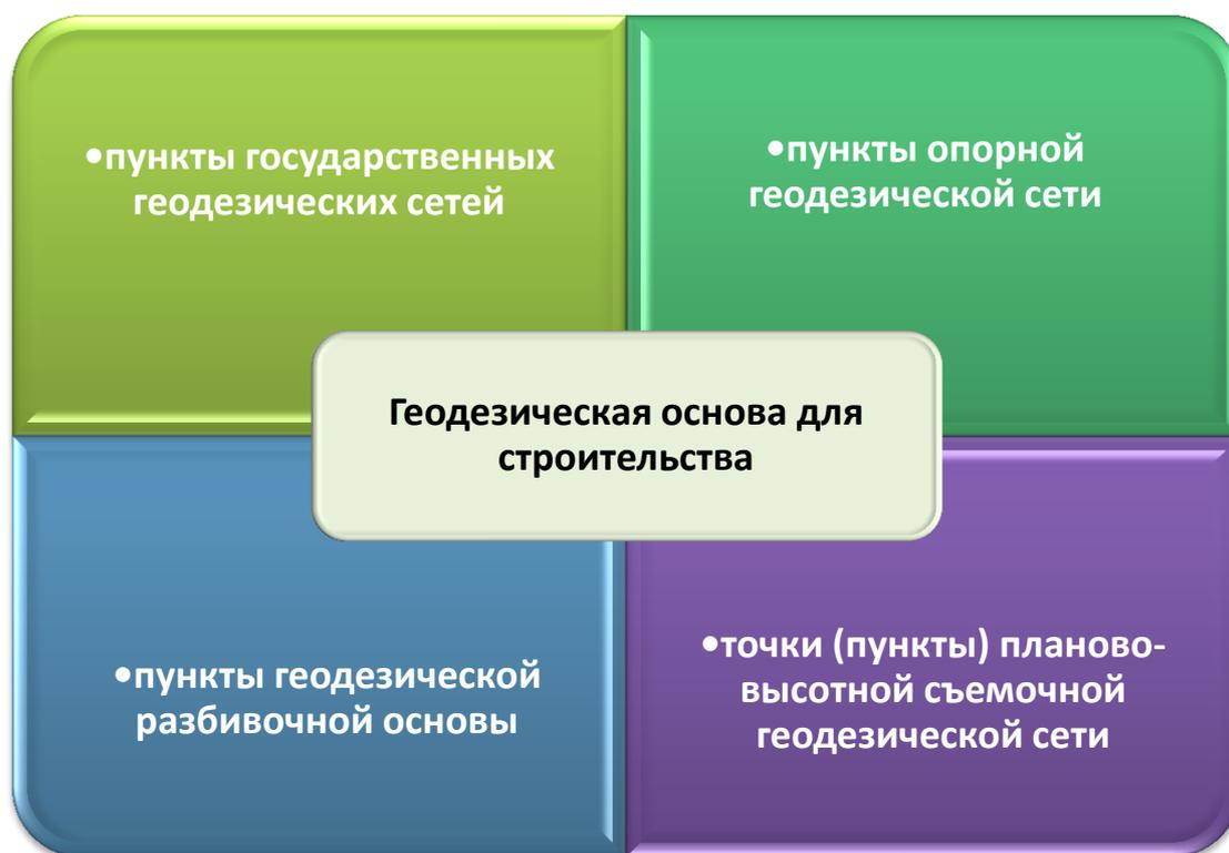
Рис. 2.1. Виды геодезической основы
