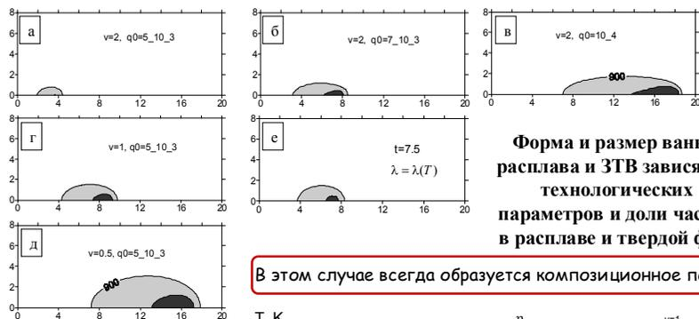
Форма и размер ванны расплава и ЗТВ зависят от технологических параметров и доли частиц в расплаве и твердой фазе
