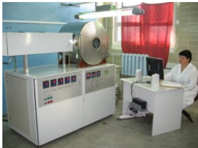
Установка нанесения влагозащитного покрытия поли-пара-ксилилен
