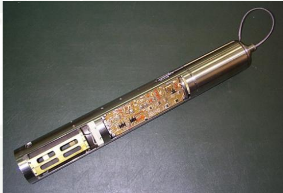
Гирскопический модуль ориентации сейсмоприемников
