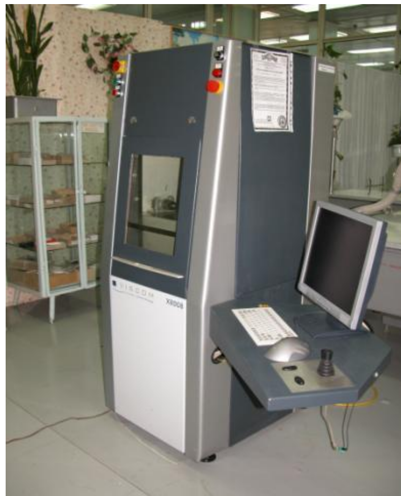
Рентгеноскопическая система контроля X8008-12 производства фирмы Viscom AG
