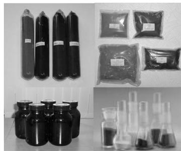
**Рис. 2. Готовая продукция (нанопорошок в различной упаковке), произведенная на предприятии ООО «Передовые порошковые технологии»**
