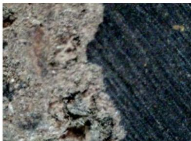
Рис. 3. Текстура гранулы твердого топлива (наполнитель - угольная мелочь) х40
