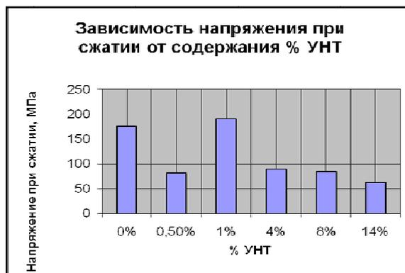
Рис. 4 – Зависимость напряжения при сжатии от содержания УНТ
