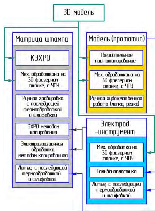
Рис.1 Блок-схема технологической последовательности нанесения рельефа на матрицу штампа
