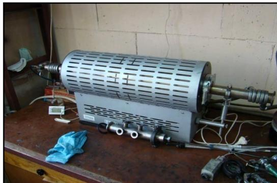
Рис. 1 - CVD установка для получения УНТ методом химического осаждения из пара.
