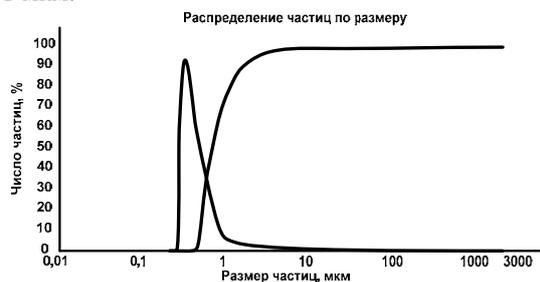
Рис. 4. Распределение частиц продуктов сгорания в зависимости от их условного (среднеповерхностного) диаметра
