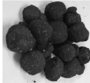
Рис. 2. Твердое формованное топливо (наполнитель – опилки, связующее – биошлам)
