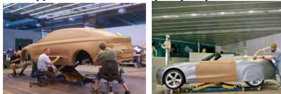
Рис.2. Доводка модели BMW 5-series и обтяжка пленкой модели BMW Z4.[3]
