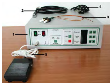
Рис.1 Внешний вид прибора: 1- генератор импульсов с системой управления и контроля, 2- передающий кабель, 3- зонд, 4- сетевой шнур, 5- педаль управления.
