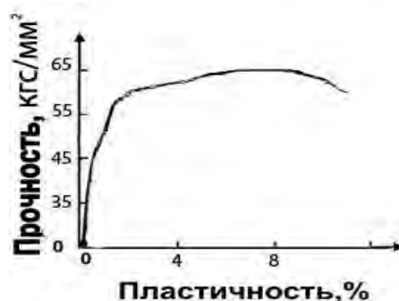
Рис.4. Кривые «прочность- пластичность» сплава В95 подвергнутого закалке и последующей деформации на 2 %
