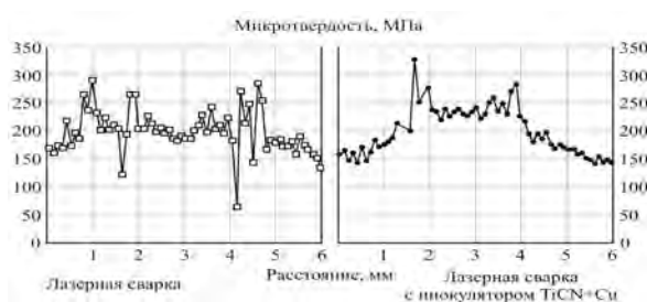
Рис. 3. Микротвердость сварных швов без инкулятора и с добавлением порошка TiCN+Cu.
