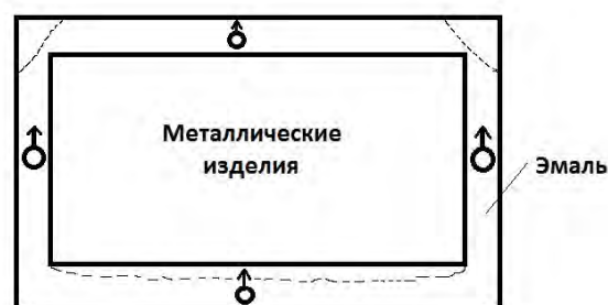
Рис.2. Схема перемещения пузырьков под действием архимедовой силы при обжиге эмалируемого изделия
