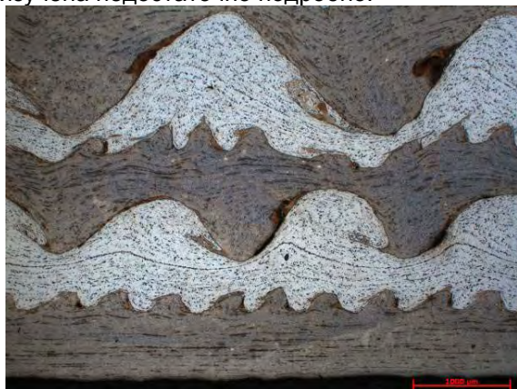
Рис.1. Граница раздела между сваренными пластинами
