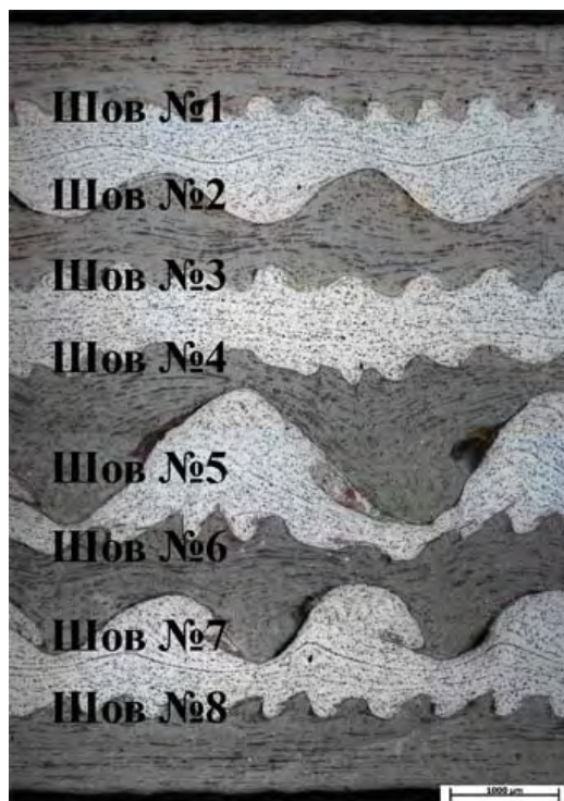
Рис.2. Структура композита в поперечном сечении, ориентированном вдоль линии продвижения точки контакта.
