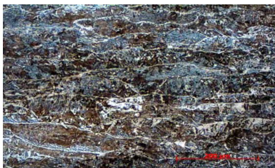
Рис. 1. Структура шва после лазерной сварки.
