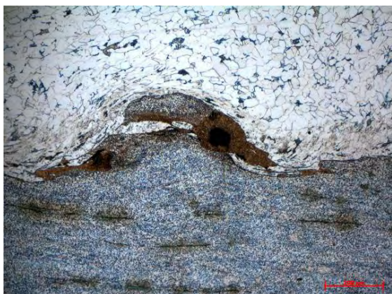
Рис.5. Мартенситная структура в зоне вихря
