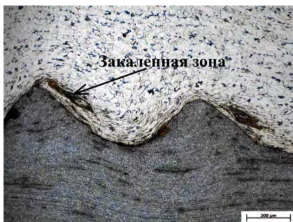
Рис.4. Интенсивная пластическая деформация ферритных зерен.
