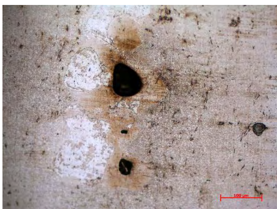
Рис.6. Разрез волны параллельно границе раздела пластин
