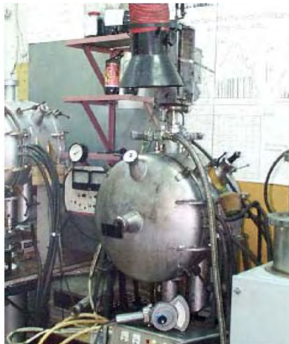
Рис. 1. Фотография установки электродугового испарения графита.
