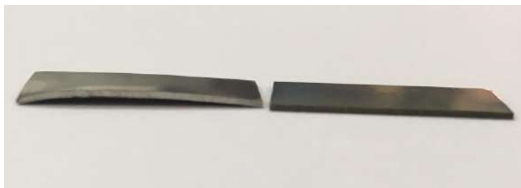
Рисунок 17. Внешний вид образцов после электроэрозионной резки (справа) и резки гильотиной (слева)
