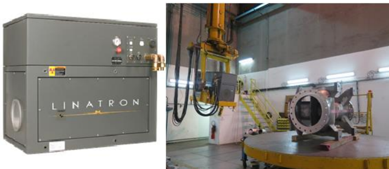
Рисунок 4 – Линейный ускоритель LINAC, используемый для неразрушающего контроля крупных стальных отливок
