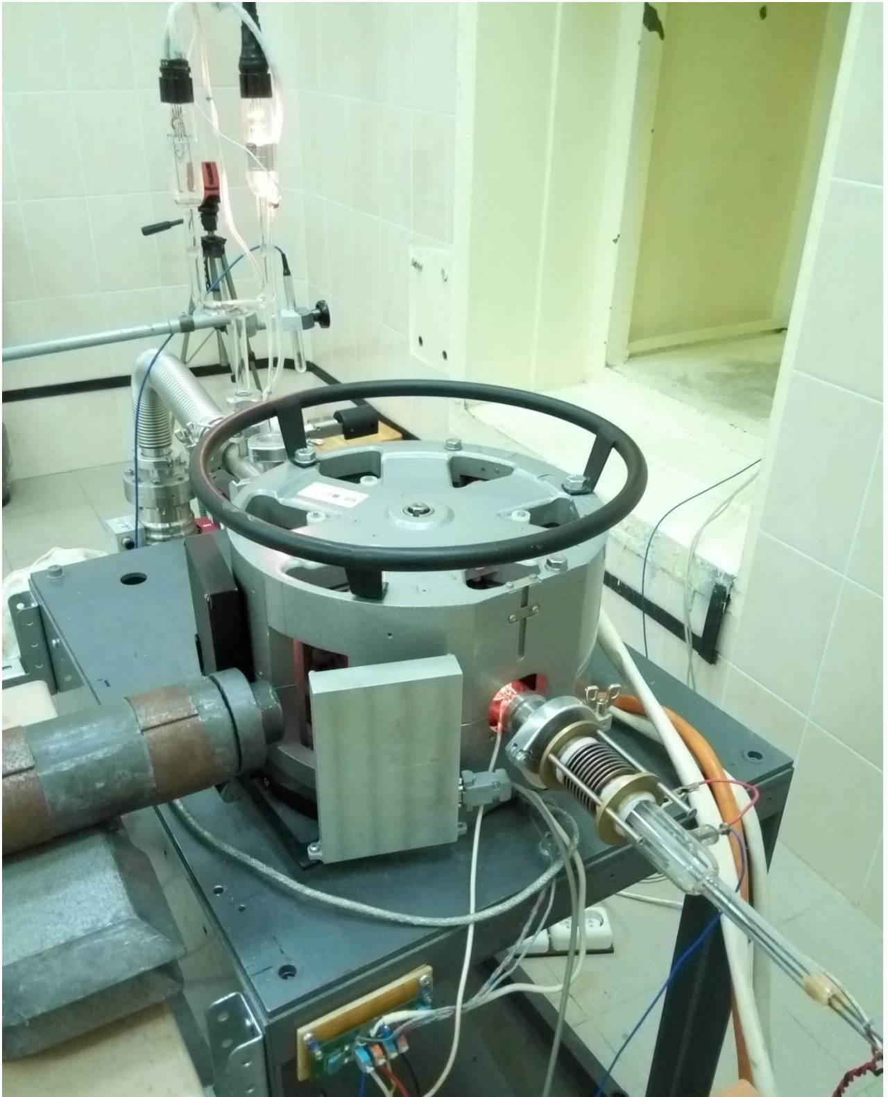
Рисунок 20 - Общий вид созданного микрофокусного источника излучения на основе бетатрона МИБ-4
