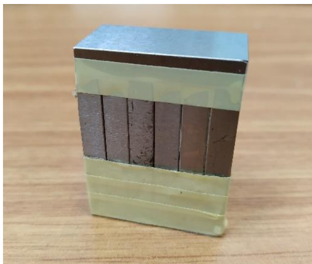
Рисунок 44 – Экспериментальный образец из шести стальных пластин с толщинами 15 мм и зазорами шириной 20 мкм между ними
