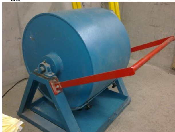
Рис. 2.2. Схема и изображение прибора Лос-Анджелес
