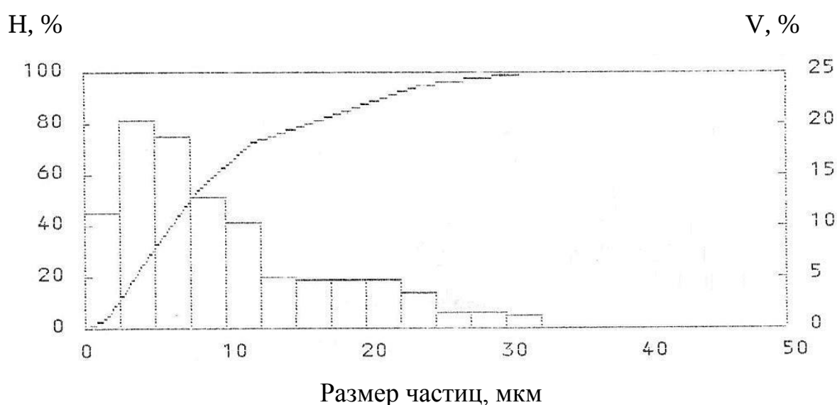
Рис. 3.3. Распределение частиц микрокремнезема по размерам и интегральная кривая по данным лазерного гранулометрического анализа.
