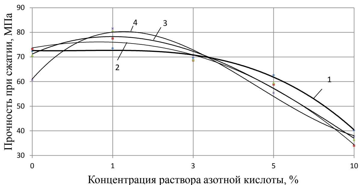
Рис. 4.8. Изменение прочности при сжатии образцов мелкозернистого бетона после выдержки в течение 28 суток в растворе азотной кислоты
