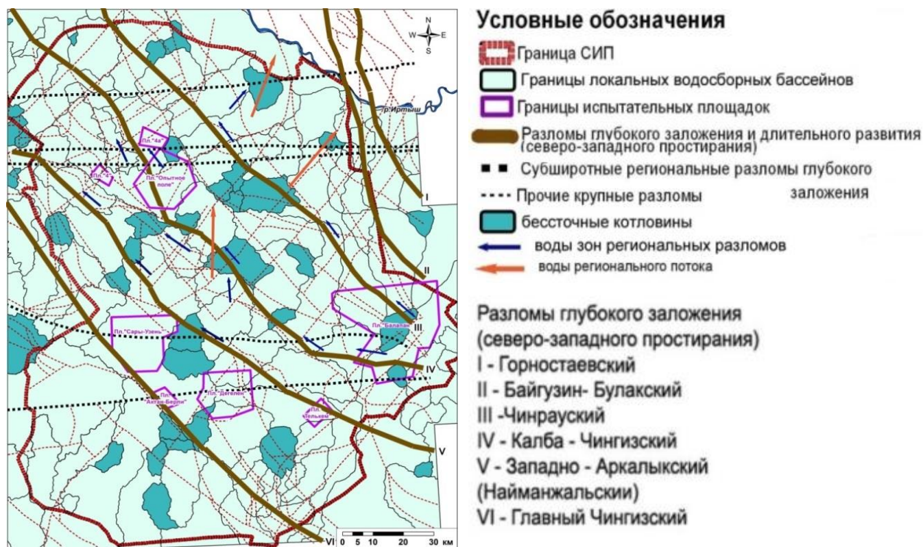
Рисунок 24 – Схема локальных водосборных бассейнов и тектонических разломов СИП
