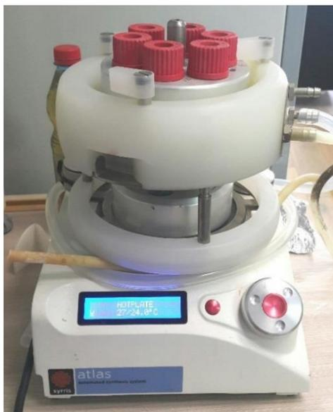
Рисунок 15 - Реактор параллельного синтеза Atlas Orbit
