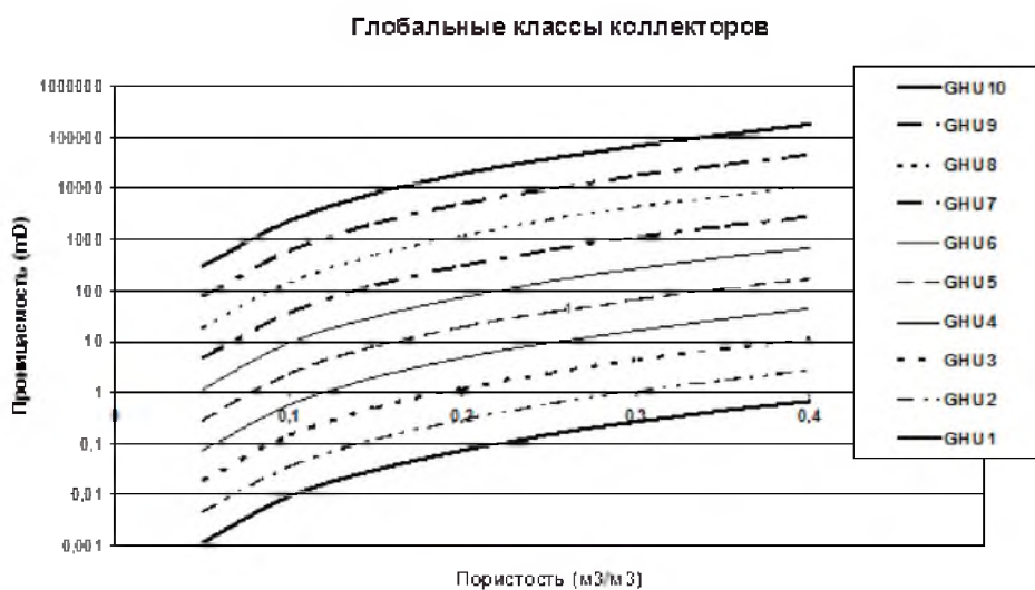
Рисунок 4.1 – Глобальная классификация коллекторов, составленная на основе выделения гидравлических единиц потока (HFU) по данным группировки индикаторов гидравлической единицы (FZI) (P.W.M. Corbett at all, 2003)
