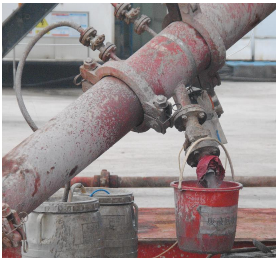
Рисунок 22 – Схема отбора продуктов разрушения забоя
