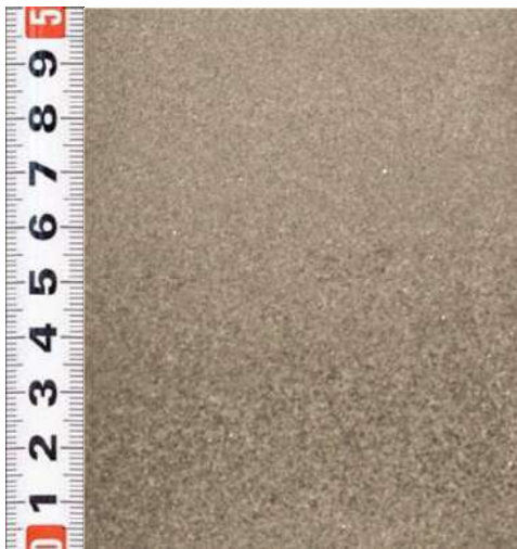
Рисунок 4.15 - Песчаник среднезернистый однородный нефтенасыщенный. Фация бара дальней зоны . Гл. 2558.46 м. Скв. 147 к. 6 Казанского месторождения
