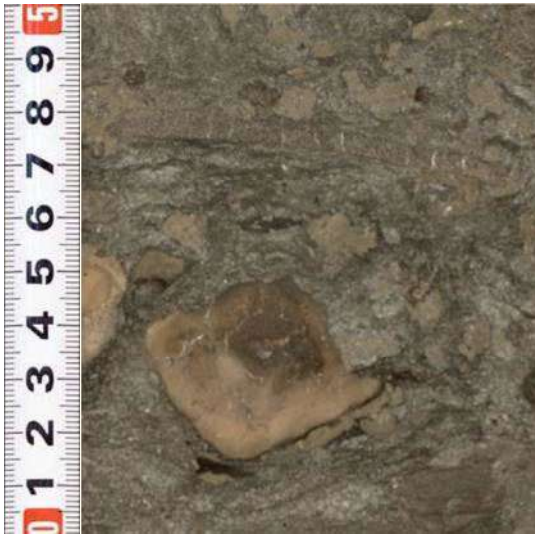
Рисунок 4.21 - Песчаник мелко-тонкозернистый глинистый биотурбированный с примесью глауконита, стяжениями пирита и конкрециями фосфоритов. Фация внешнего шельфа . Гл. 2572.10 м. Сkv. 113 к. 11 Казанского месторождения
