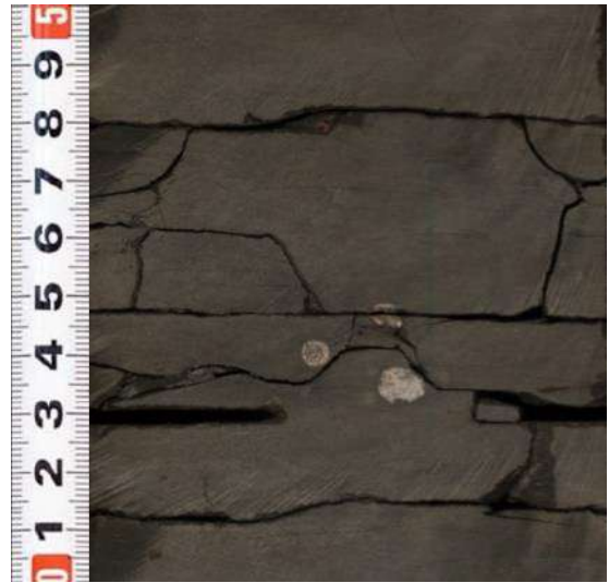
Рисунок 4.24 - Аргиллит горизонтальнослоистый с единичными рострами белемнитов. Фация пелагиали . Гл. 2502.26 м. Скв. 122 к. 11 Казанского месторождения
