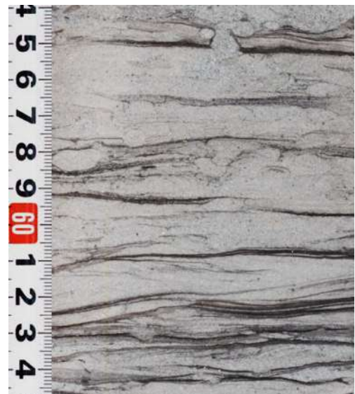
Рисунок 4.14 - Песчаник тонко-мелкозернистый с прерывистой косо́й слоистостью течения с многочисленными тонкими иловыми прослоями и следами биотурбации Macaronichnus . Фация приливно-отливной зоны . Гл. 2505.8 м. Скв. 17 Казанского месторождения
