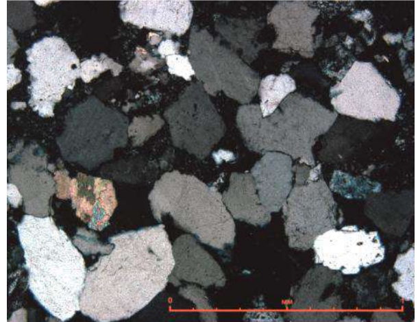
Рисунок 3.18 - Песчаник мезомиктовый кварцевый мелко-среднезернистый с поровым каолиновым и поровым кальцитовым цементом; текстура однородная (Казанская-663, гл. 2634,59 м). Николи И и Х
