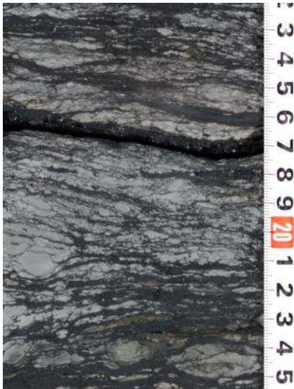
Рисунок 4.17 - Переслаивание тонкое угля и песчаника тонкозернистого алевритистого сильно биотурбированное. Встречаются пиритовые конкреции. Фация марша . Гл. 2503.90 м. Скв. 16Р Казанского месторождения
