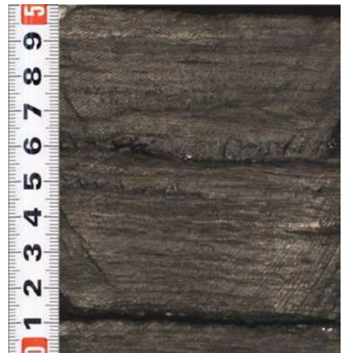
Рисунок 4.8 - Уголь хрупкий с жирным и матовым блеском. Фация болота . Гл. 2573.62 м. Скв. 147 к. 6 Казанского месторождения
