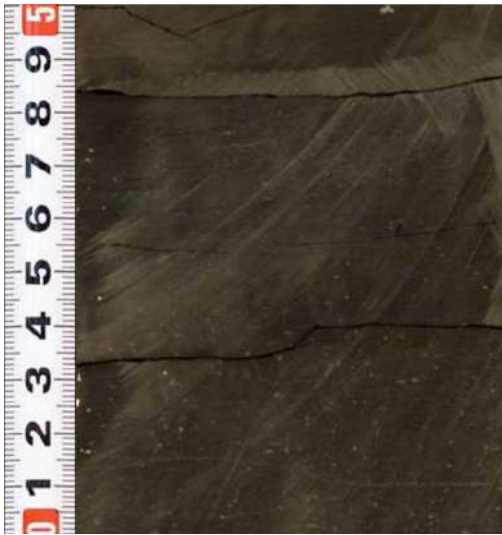
Рисунок 4.23 - Аргиллит с рассеянными глобулами пирита. Фация пелагиали . Гл. 2547.10 м. Скв. 147 к. 6 Казанского месторождения
