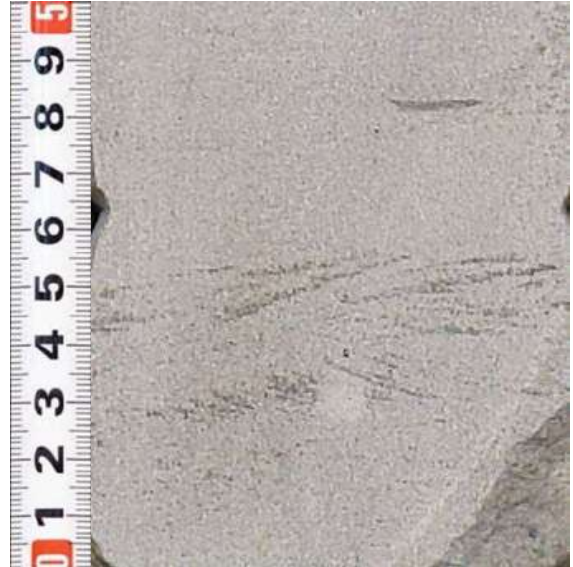
Рисунок 4.10 - Песчаник мелкозернистый с двунаправленной косою слоистостью типа «рыбья кость», подчеркнутой прерывистыми глинистыми слойками. Фация приливно-го канала . Гл. 2485.90 м. Скв. 15Р Казанского месторождения
