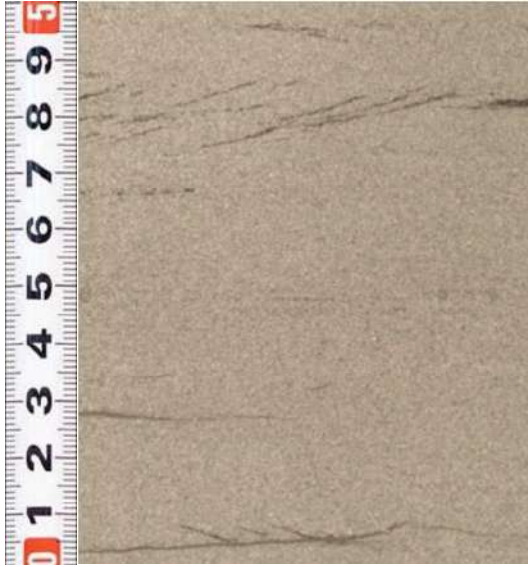
Рисунок 4.9 - Песчаник мелкозернистый с косою слоистостью, подчеркнутой слюдисто-углистым материалом. Фация приливно-го канала . Гл. 2564.34 м. Скв. 147 к. 6 Казанского месторождения
