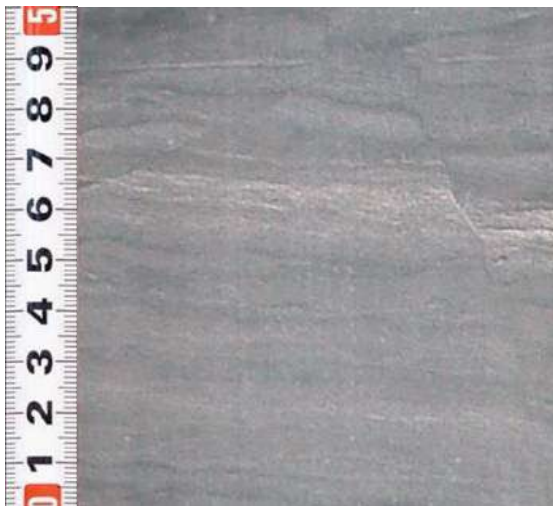
Рисунок 4.7 - Алевролит глинисто-песчаный с горизонтальной и градационной слоистостью, с редкими песчаными прослоями и трещинами уплотнения. Фация озера . Гл. 2463.10 м. Скв. 15Р Казанского месторождения
