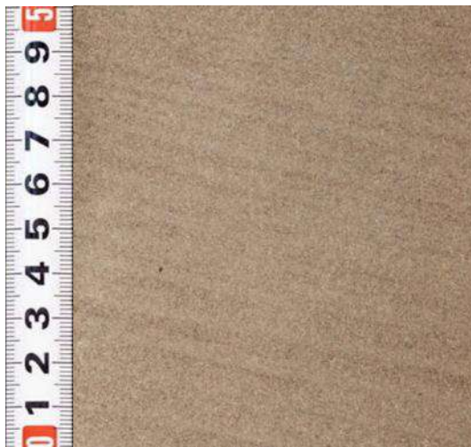
Рисунок 4.3 - Песчаник мелкозернистый с плоскопараллельной косой слоистостью. Фация аккреционного комплекса русел и кос . Глубина 2661,79 м. Скв. 663 Казанского месторождения
