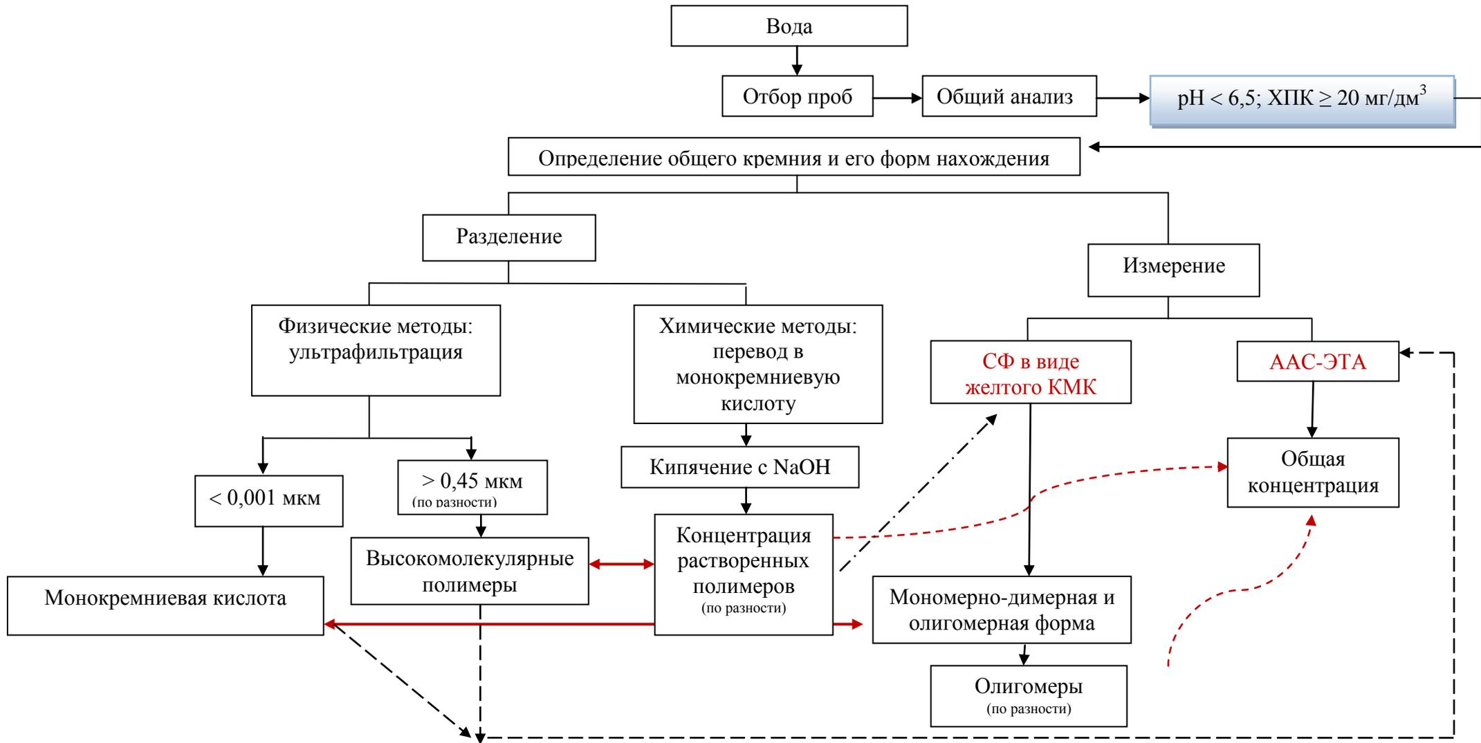
Рисунок 29 (а) – Схема определения общей концентрации и форм нахождения кремния в водах с высоким содержанием РОВ
