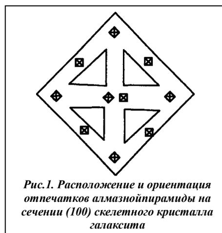
Рис.1. Расположение и ориентация отпечатков алмазной пирамиды на сечении (100) скелетного кристалла галаксита
