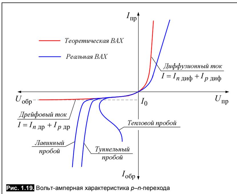
Рис. 1.19. Вольт-амперная характеристика p-n-перехода
