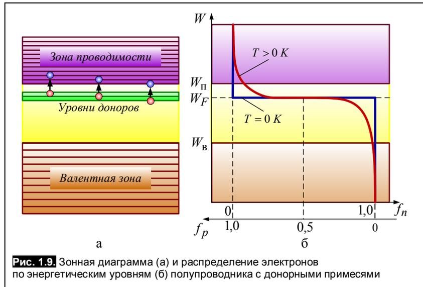
Рис. 1.9. Зонная диаграмма (а) и распределение электронов по энергетическим уровням (б) полупроводника с донорными примесями
