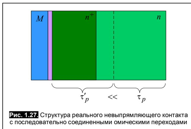
Рис. 1.27. Структура реального невыпрямляющего контакта с последовательно соединенными омическими переходами
