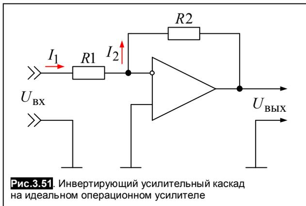
Рис.3.51. Инвертирующий усилительный каскад на идеальном операционном усилителе
