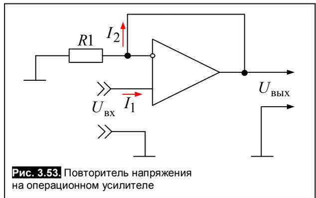
Рис. 3.53. Повторитель напряжения на операционном усилителе
