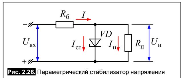
Рис. 2.26. Параметрический стабилизатор напряжения
