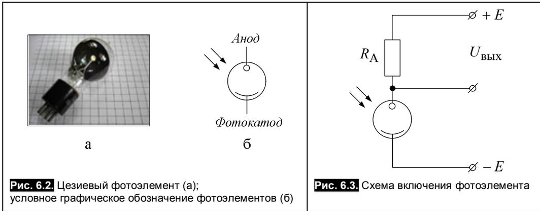
Рис. 6.2. Цезиевый фотоэлемент (а); условное графическое обозначение фотоэлементов (б)
