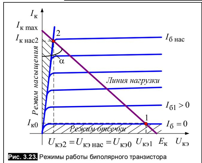
Рис. 3.23. Режимы работы биполярного транзистора
