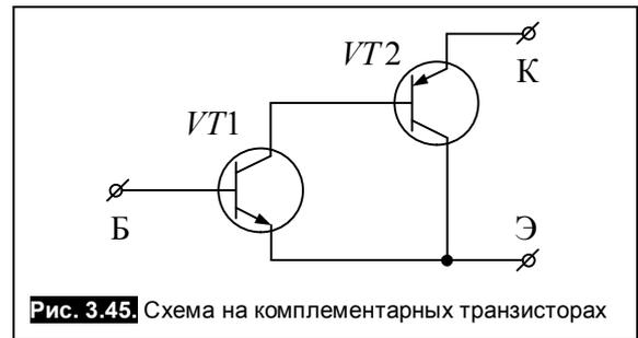
Рис. 3.45. Схема на комплементарных транзисторах
