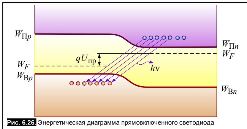
Рис. 6.26. Энергетическая диаграмма прямовключенного светодиода
