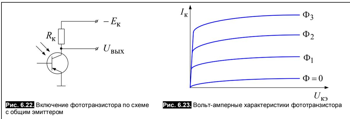
**Рис. 6.22.** Включение фототранзистора по схеме с общим эмиттером
