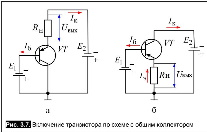
Рис. 3.7. Включение транзистора по схеме с общим коллектором
