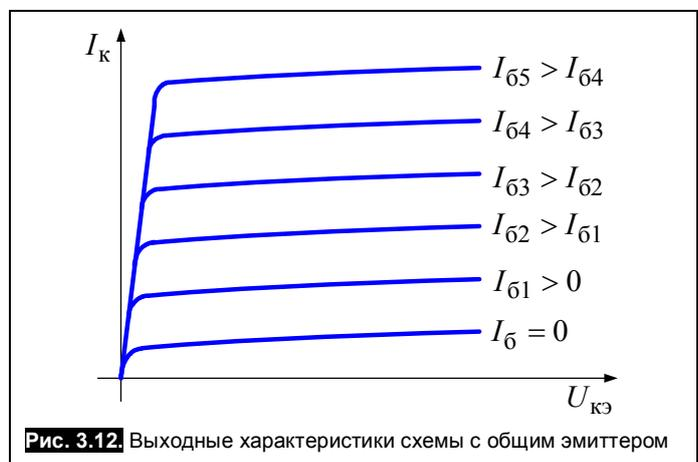
Рис. 3.12. Выходные характеристики схемы с общим эмиттером
