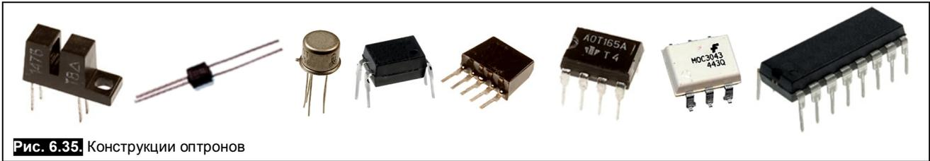
**Рис. 6.35.** Конструкции оптронов
