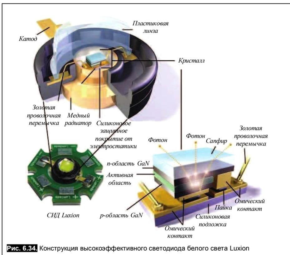
Рис. 6.34. Конструкция высокоэффективного светодиода белого света Luxip
