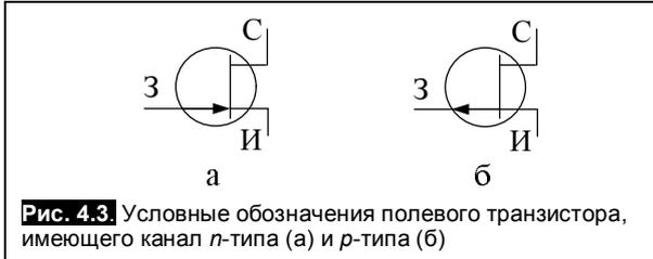
**Рис. 4.3.** Условные обозначения полевого транзистора, имеющего канал  $n$ -типа (а) и  $p$ -типа (б)
