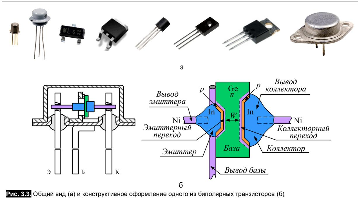
Рис. 3.3. Общий вид (а) и конструктивное оформление одного из биполярных транзисторов (б)
