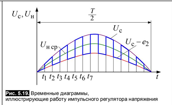
Рис. 5.19. Временные диаграммы, иллюстрирующие работу импульсного регулятора напряжения
