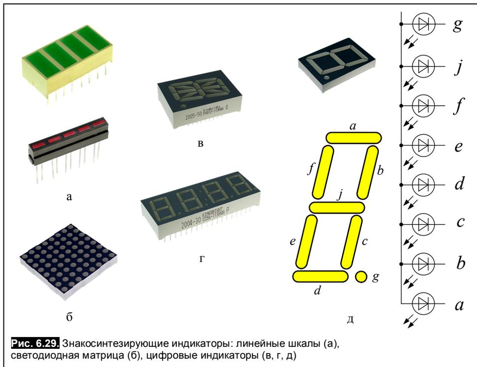
**Рис. 6.29.** Знакосинтезирующие индикаторы: линейные шкалы (а), светодиодная матрица (б), цифровые индикаторы (в, г, д)
