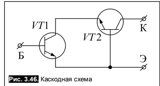
Рис. 3.46. Каскадная схема
