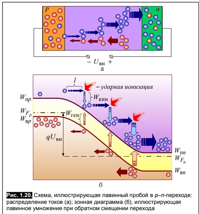
Рис. 1.20. Схема, иллюстрирующая лавинный пробой в  $p$ - $n$ -переходе: распределение токов (а); зонная диаграмма (б), иллюстрирующая лавинное умножение при обратном смещении перехода
