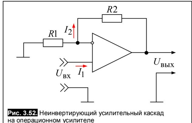
Рис. 3.52. Неинвертирующий усилительный каскад на операционном усилителе
