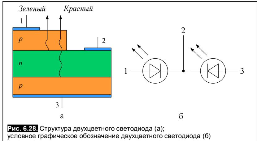
**Рис. 6.28.** Структура двухцветного светодиода (а); условное графическое обозначение двухцветного светодиода (б)
