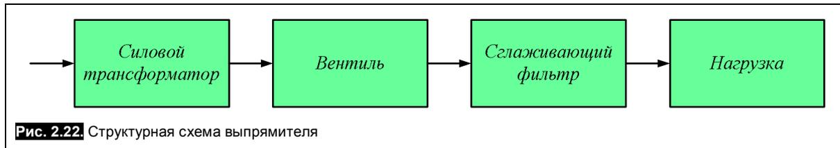
Рис. 2.22. Структурная схема выпрямителя
