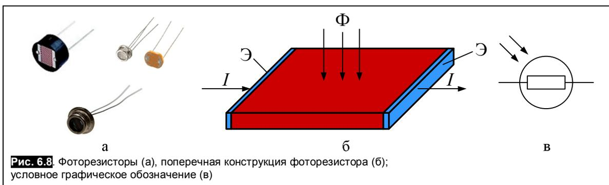
Рис. 6.8 Фоторезисторы (а), поперечная конструкция фоторезистора (б); условное графическое обозначение (в)
