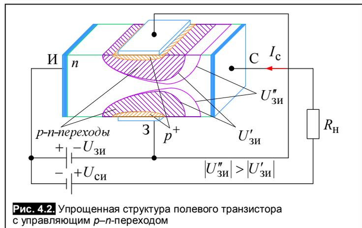
**Рис. 4.2.** Упрощенная структура полевого транзистора с управляющим *p-n*-переходом
