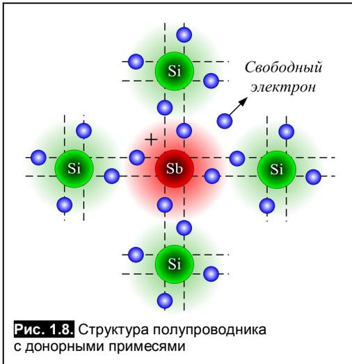
Рис. 1.8. Структура полупроводника с донорными примесями
