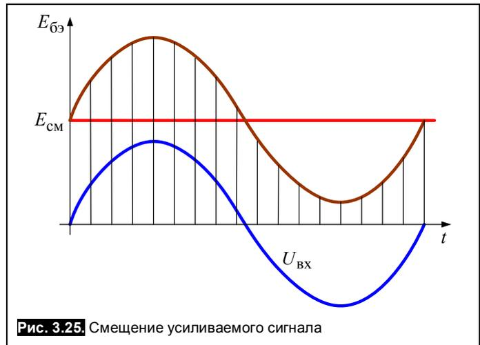
**Рис. 3.25.** Смещение усиливаемого сигнала
