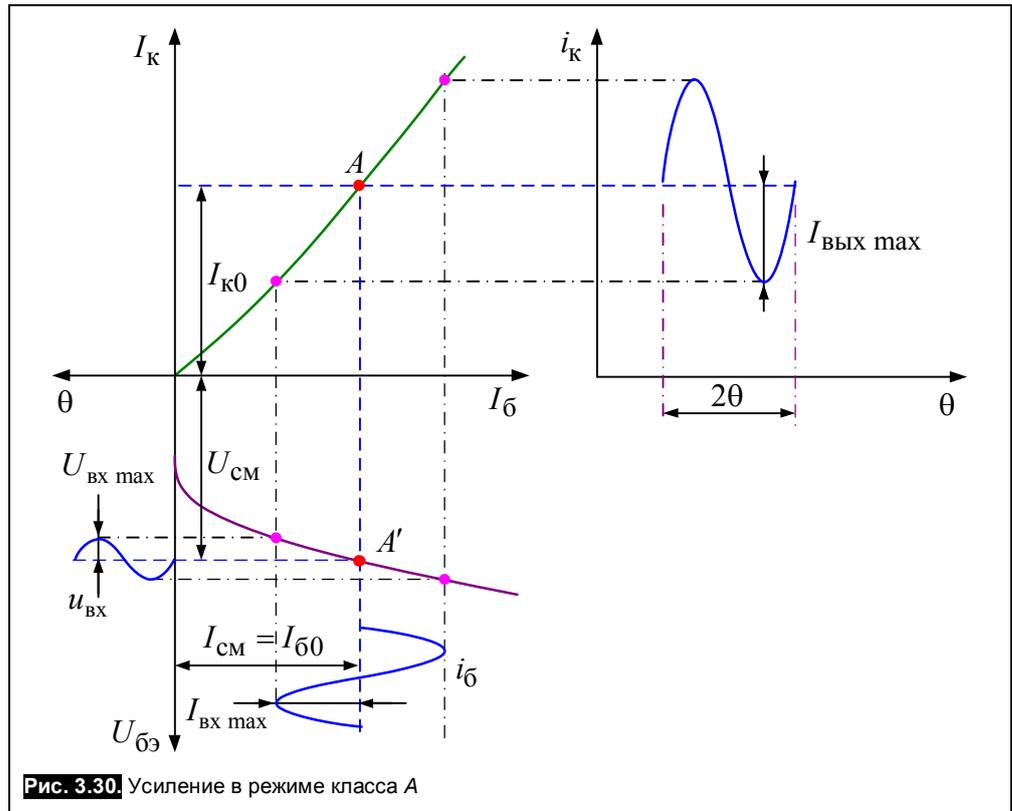
Рис. 3.30. Усиление в режиме класса А
