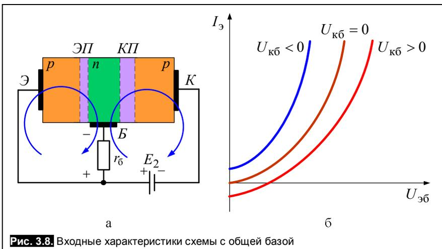
Рис. 3.8. Входные характеристики схемы с общей базой
