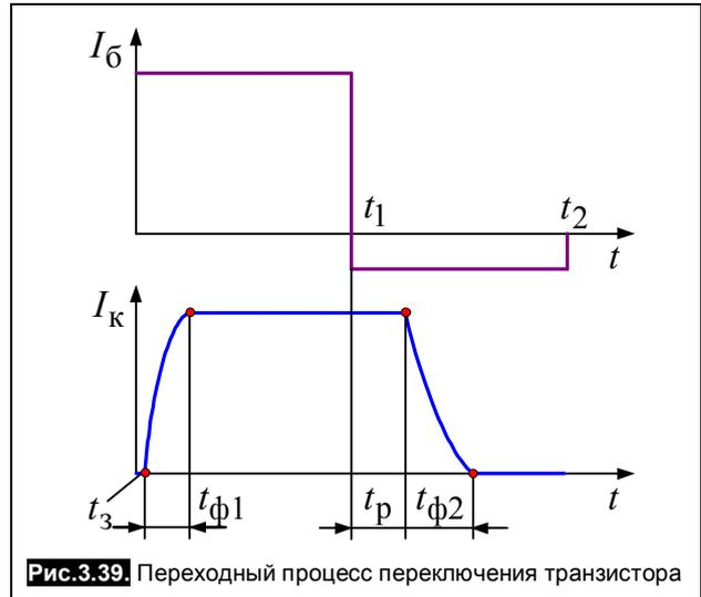
Рис. 3.39. Переходный процесс переключения транзистора
