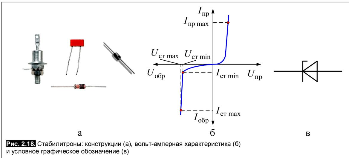
Рис. 2.18. Стабилитроны: конструкции (а), вольт-амперная характеристика (б) и условное графическое обозначение (в)
