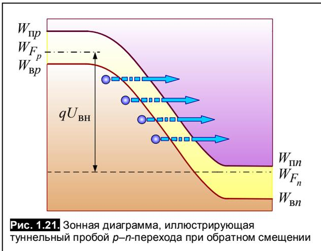
Рис. 1.21. Зонная диаграмма, иллюстрирующая туннельный пробой  $p$ - $n$ -перехода при обратном смещении
