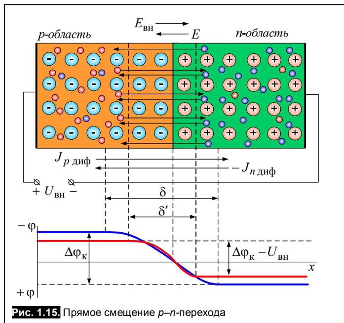
чением  $p-n$ -перехода (или прямым смещением  $p-n$ -перехода). Тогда напряженность электрического поля внешнего источника  $E_{вн}$  будет направлена навстречу напряженности поля потенциального барьера  $E$  и, следовательно, приведет к снижению результирующей напряженности  $E_{рез}$ :
