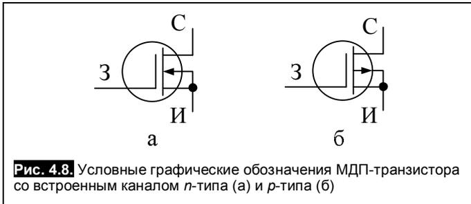
Рис. 4.8. Условные графические обозначения МДП-транзистора со встроенным каналом  $n$ -типа (а) и  $p$ -типа (б)
