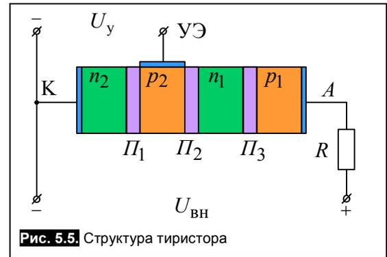
Для рассмотрения этого явления представим тиристор в виде двух, объединенных в одну схему транзисторов  $VT1$  и  $VT2$  (**рис. 5.6, а**), типа  $p$ - $n$ - $p$  и  $n$ - $p$ - $n$ , соответственно. Оба транзистора включены по схеме с общим эмиттером (**рис. 5.6, б**).
