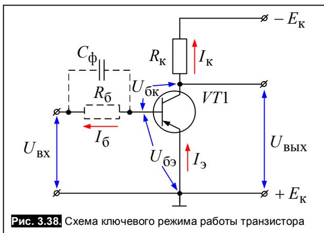
Рис. 3.38. Схема ключевого режима работы транзистора
