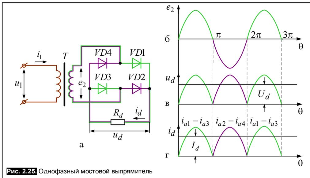
Рис. 2.25. Однофазный мостовой выпрямитель
