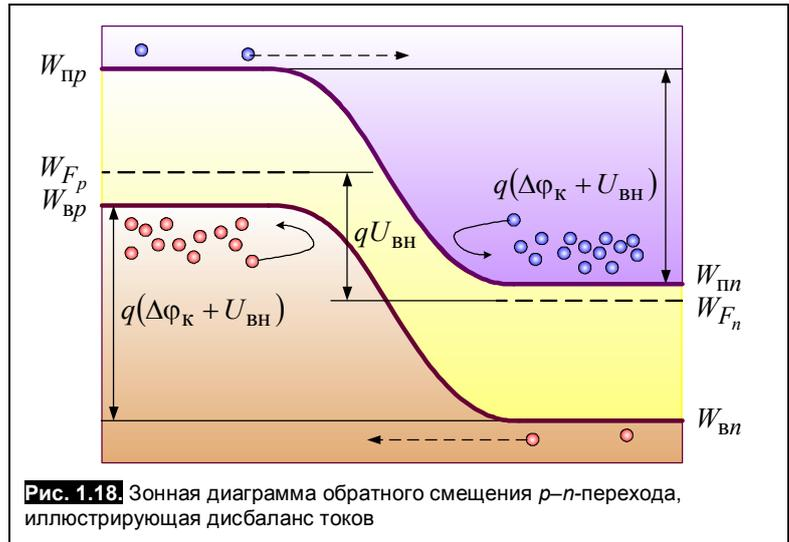
**Рис. 1.18.** Зонная диаграмма обратного смещения  $p$ - $n$ -перехода, иллюстрирующая дисбаланс токов
