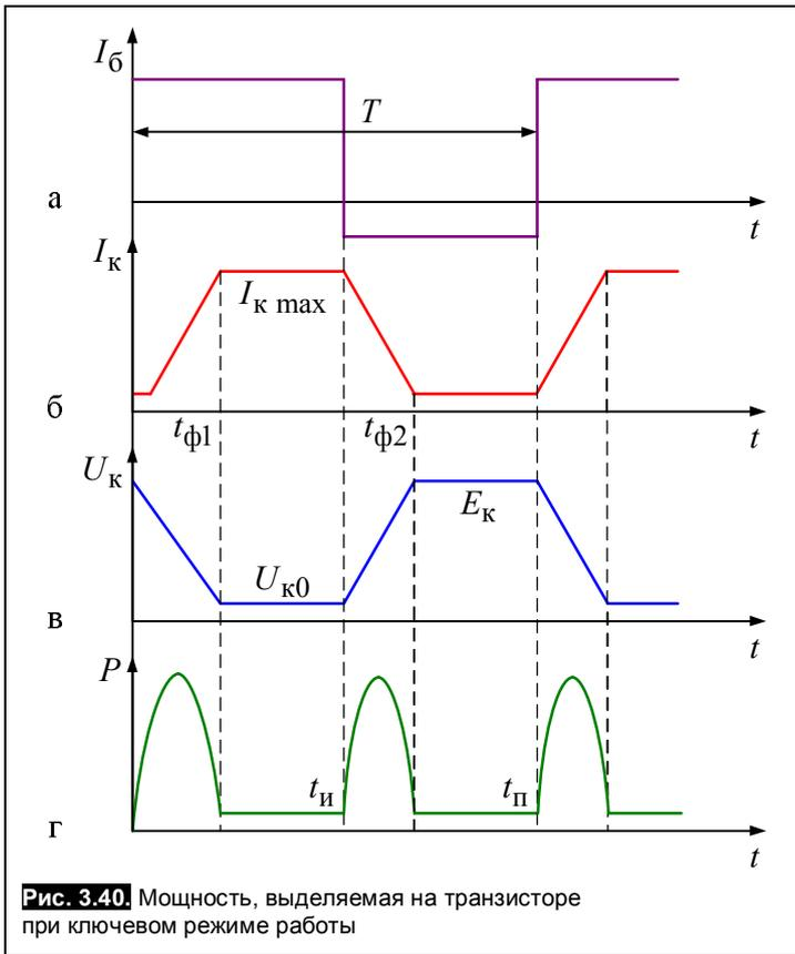
Рис. 3.40. Мощность, выделяемая на транзисторе при ключевом режиме работы
