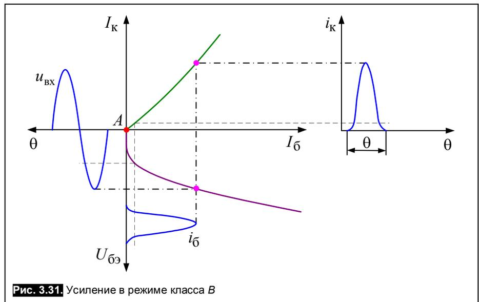
Рис. 3.31. Усиление в режиме класса В
