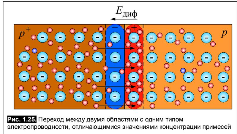
Рис. 1.25. Переход между двумя областями с одним типом электропроводности, отличающимися значениями концентрации примесей
