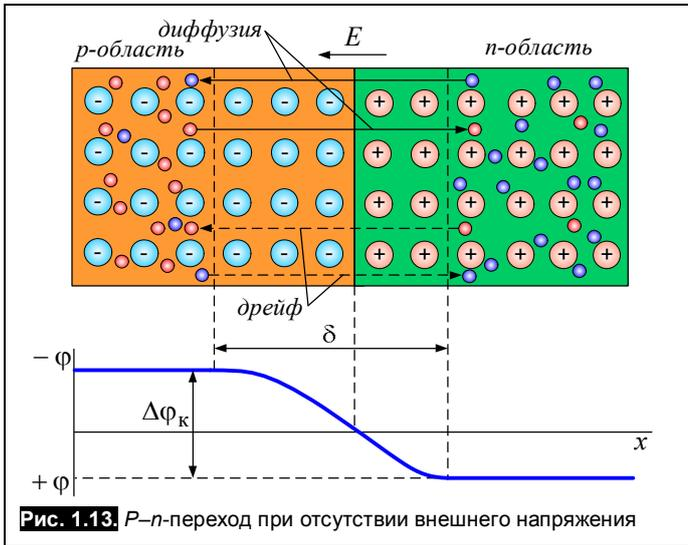
И в первую очередь не скомпенсированные заряды ионов примесей проявляют себя вблизи границы раздела (рис. 1.13), где образуется слой пространственных зарядов, разделенных узким промежутком  $\delta$ . Между этими зарядами возникает электрическое поле с напряжённостью  $E$ , которое называют *полем потенциального барьера*, а разность потенциалов на границе раздела двух зон, обуславливающих это поле, называют *контактной разностью потенциалов*  $\Delta\varphi_k$ .
