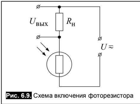
Рис. 6.9. Схема включения фоторезистора
