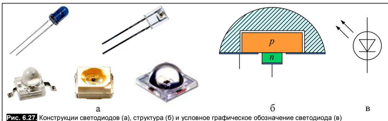
Рис. 6.27. Конструкции светодиодов (а), структура (б) и условное графическое обозначение светодиода (в)
