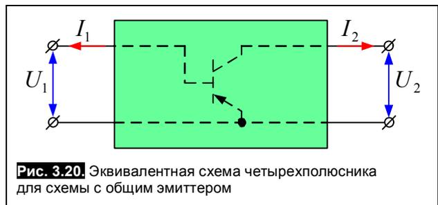
Рис. 3.20. Эквивалентная схема четырехполюсника для схемы с общим эмиттером
