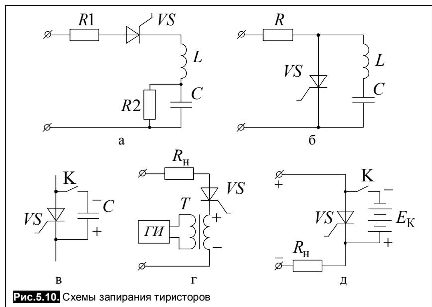
4. Подключение параллельно тиристоры источника коммутирующей ЭДС (рис. 5.10, д). Выключение тиристора осуществляется замыканием в нужный момент времени ключа  $K$  на короткий промежуток времени, определяемый временем рассасывания неосновных носителей в зонах полупроводника.
