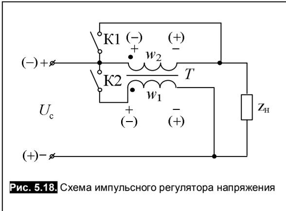
Рис. 5.18. Схема импульсного регулятора напряжения
