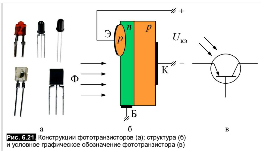
Рис. 6.21. Конструкции фототранзисторов (а); структура (б) и условное графическое обозначение фототранзистора (в)
