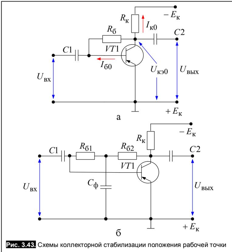
Рис. 3.43. Схемы коллекторной стабилизации положения рабочей точки
