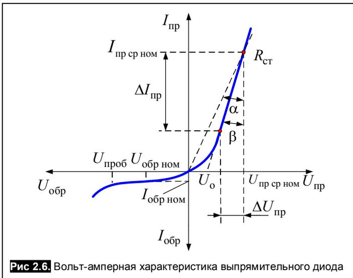
**Рис. 2.6.** Вольт-амперная характеристика выпрямительного диода
