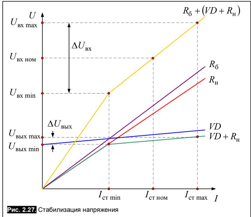
Рис. 2.27. Стабилизация напряжения
