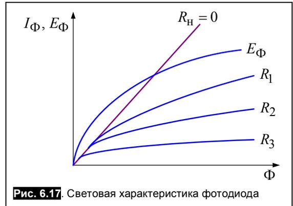
Рис. 6.17. Световая характеристика фотодиода
