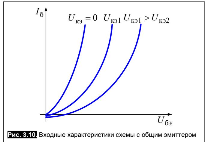
Рис. 3.10. Входные характеристики схемы с общим эмиттером
