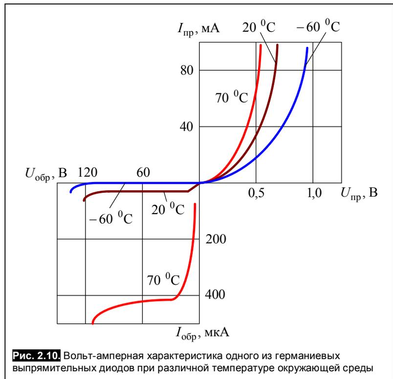
Рис. 2.10. Вольт-амперная характеристика одного из германиевых выпрямительных диодов при различной температуре окружающей среды
