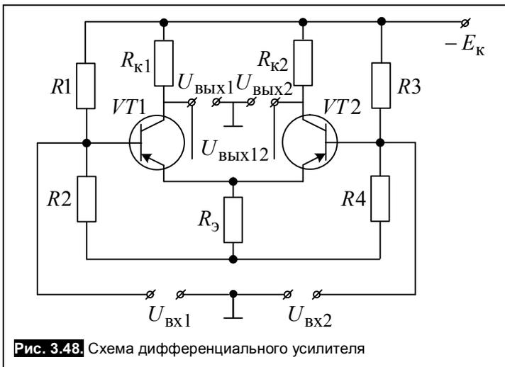
Рис. 3.48. Схема дифференциального усилителя
