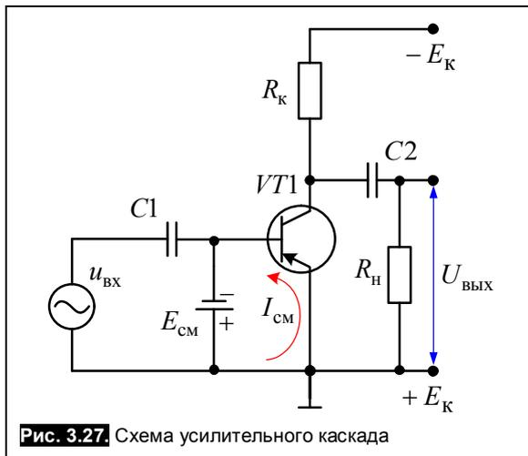
Рассмотрим работу транзисторного усилительного каскада, включенного по схеме с общим эмиттером (рис. 3.27). Если входной сигнал отсутствует ( $u_{BX} = 0$ ), линия нагрузки может быть построена описанным ранее методом по двум точкам:  $E_K$  на оси абсцисс и  $I_{K \max} = \frac{E_K}{R_K}$  на оси ординат.
