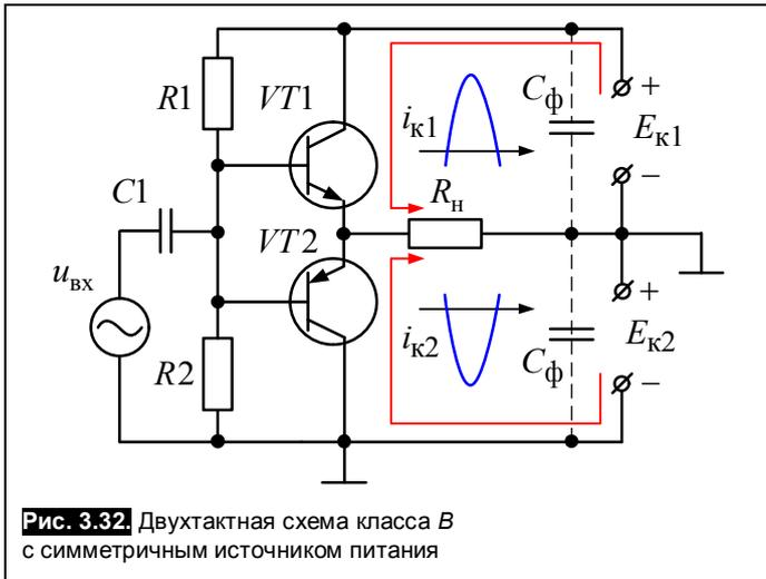
Рис. 3.32. Двухтактная схема класса В с симметричным источником питания
