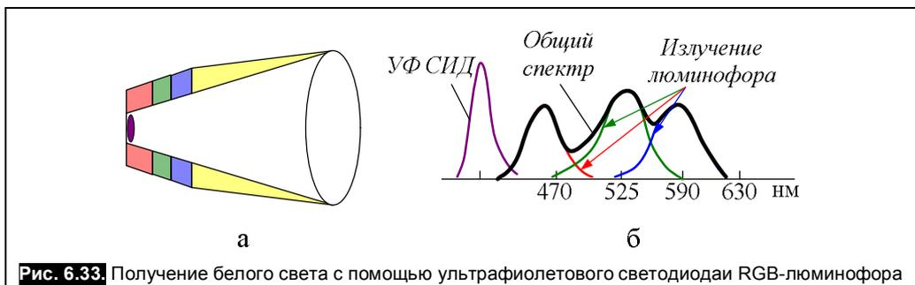
Светоотдача (световой поток на единицу потребляемой мощности) белых светодиодов ниже, чем у светодиодов с узким спектром излучения, потому что в них происходит двойное преобразование энергии, часть её теряется в люминофоре. В настоящее время светоотдача лучших белых светодиодов (к примеру, **рис. 6.34**) доходит до  $65 \dots 75, \frac{\text{лм}}{\text{Вт}}$ .
