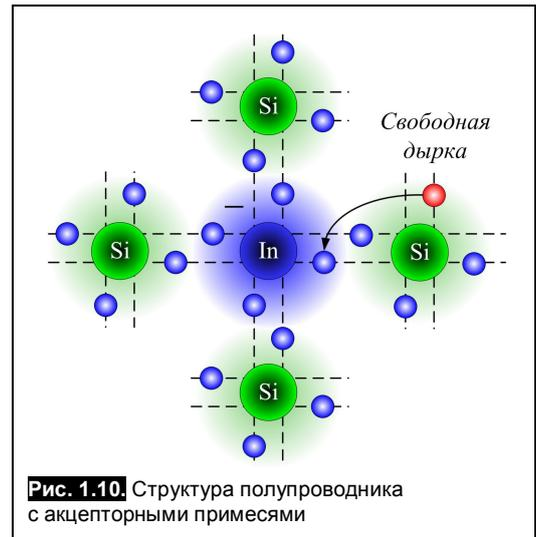
Рис. 1.10. Структура полупроводника с акцепторными примесями
