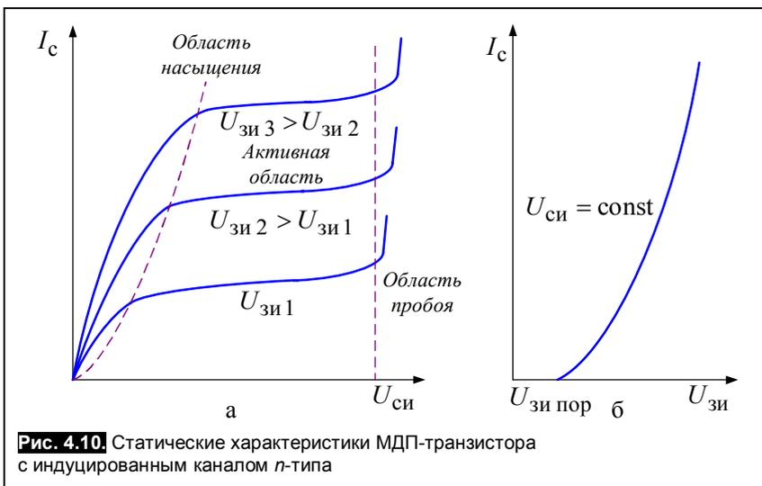
Рис. 4.10. Статические характеристики МДП-транзистора с индуцированным каналом  $n$ -типа
