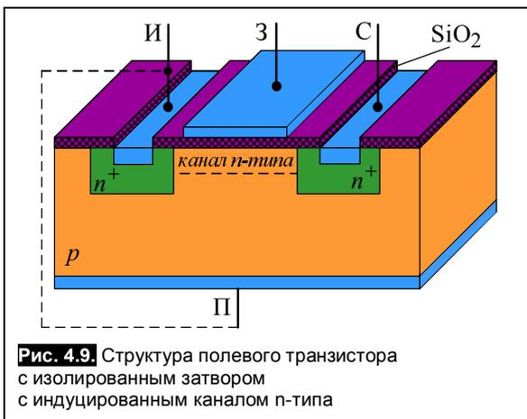
Рис. 4.9. Структура полевого транзистора с изолированным затвором с индуцированным каналом  $n$ -типа
