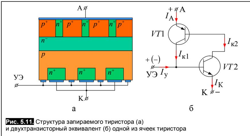
Рис. 5.11. Структура запираемого тиристора (а) и двухтранзисторный эквивалент (б) одной из ячеек тиристора
