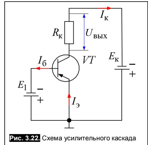
Рис. 3.22. Схема усилительного каскада
