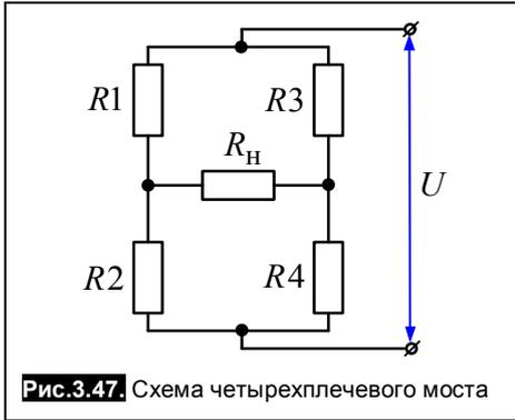
Рис.3.47. Схема четырехплечевого моста
