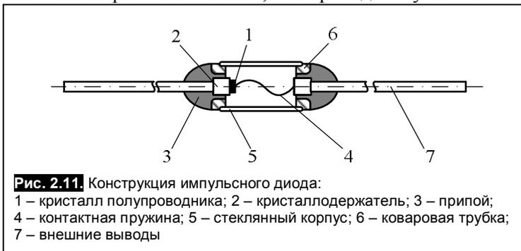
В связи с недостатками точечных диодов они практически полностью вытеснены импульсными диодами, производство которых основано на современных производительных и контролируемых методах формирования  $p$ - $n$ -переходов (планарной технологии, эпитаксиального наращивания). Основным исходным полупроводниковым материалом при этом служит кремний, а иногда арсенид галлия.
