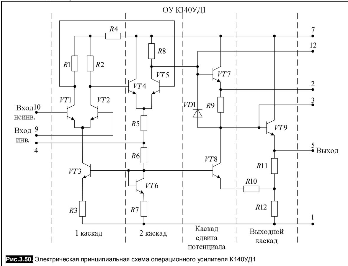
Рис.3.50. Электрическая принципиальная схема операционного усилителя К140УД1
