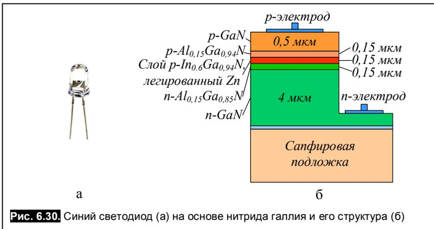
Рис. 6.30. Синий светодиод (а) на основе нитрида галлия и его структура (б)
