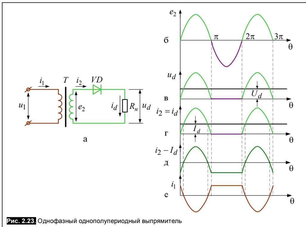
Рис. 2.23. Однофазный однополупериодный выпрямитель
