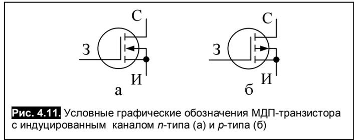
**Рис. 4.11.** Условные графические обозначения МДП-транзистора с индуцированным каналом  $n$ -типа (а) и  $p$ -типа (б)
