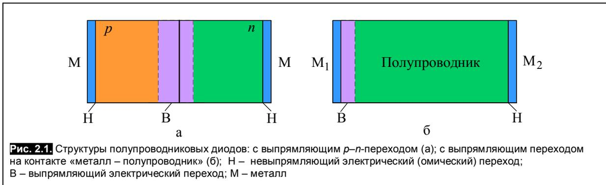
**Рис. 2.1.** Структуры полупроводниковых диодов: с выпрямляющим  $p-n$ -переходом (а); с выпрямляющим переходом на контакте «металл – полупроводник» (б); Н – невыпрямляющий электрический (омический) переход; В – выпрямляющий электрический переход; М – металл
