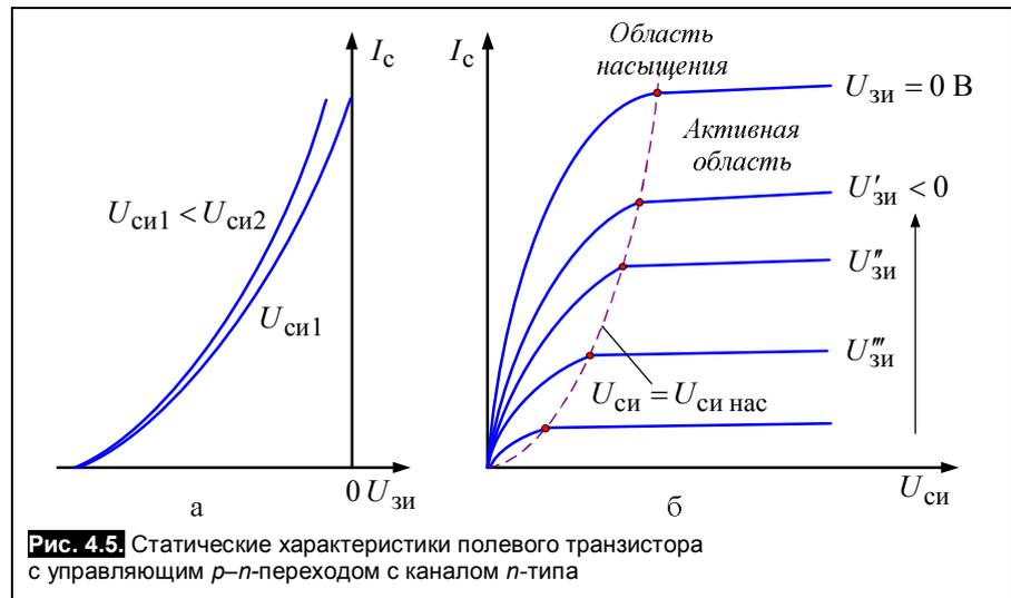
Рис. 4.5. Статические характеристики полевого транзистора с управляющим  $p-n$ -переходом с каналом  $n$ -типа
