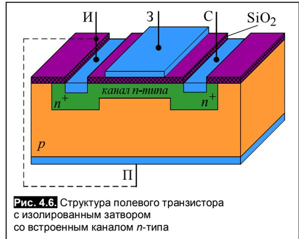
**Рис. 4.6.** Структура полевого транзистора с изолированным затвором со встроенным каналом  $n$ -типа
