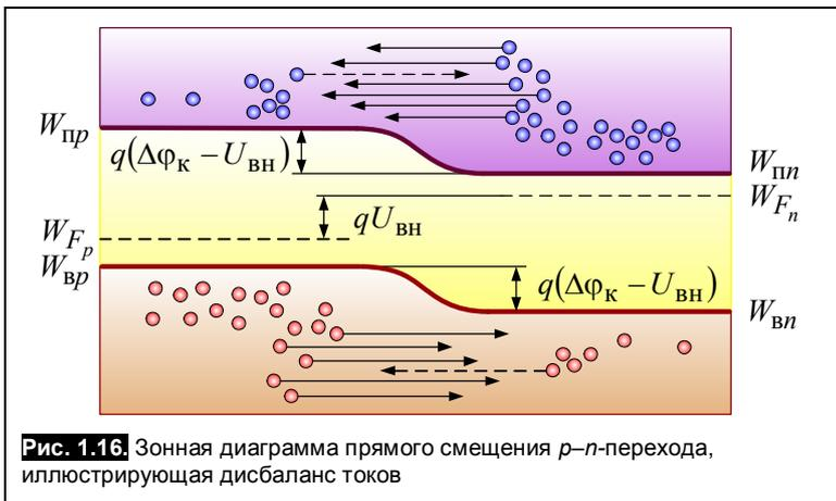
Рис. 1.16. Зонная диаграмма прямого смещения  $p-n$ -перехода, иллюстрирующая дисбаланс токов
