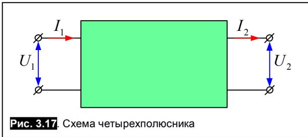
Рис. 3.17. Схема четырехполюсника
