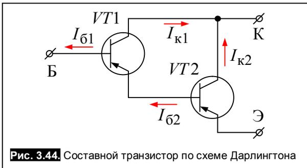
Рис. 3.44. Составной транзистор по схеме Дарлингтона
