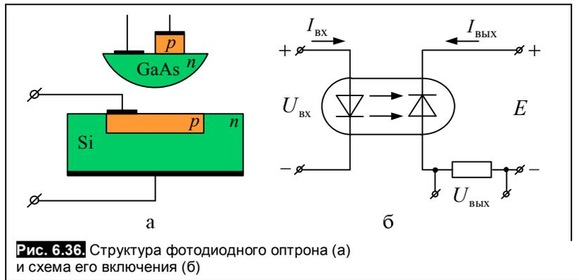
**Рис. 6.36.** Структура фотодиодного оптрона (а) и схема его включения (б)
