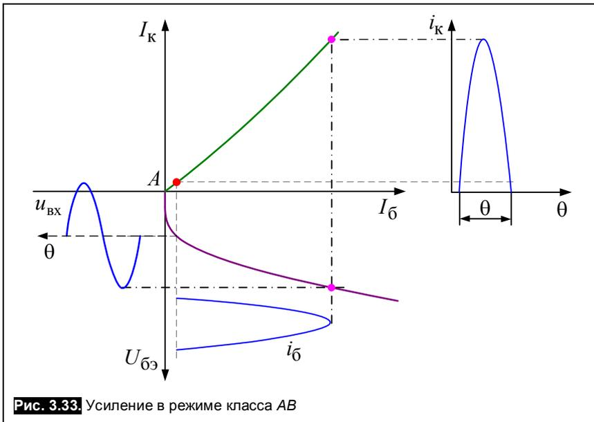
Рис. 3.33. Усиление в режиме класса АВ
