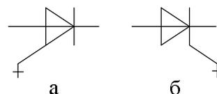
Рис. 5.13. Условные обозначения запираемых тринисторов с управлением по аноду (а), с управлением по катоду (б)
