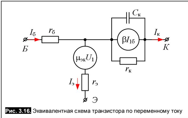
Рис. 3.16. Эквивалентная схема транзистора по переменному току
