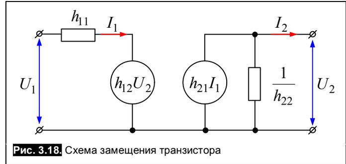
Рис. 3.18. Схема замещения транзистора
