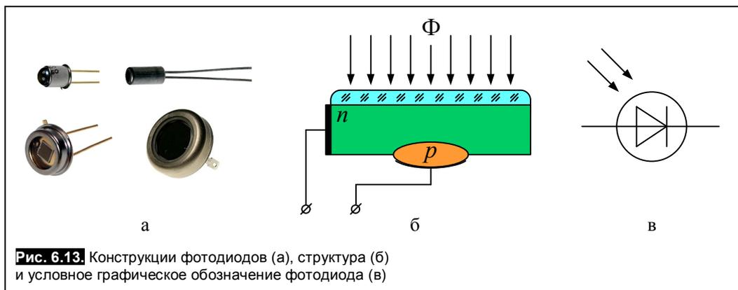
Рис. 6.13. Конструкции фотодиодов (а), структура (б) и условное графическое обозначение фотодиода (в)
