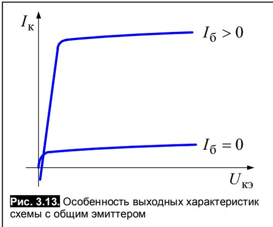
Рис. 3.13. Особенность выходных характеристик схемы с общим эмиттером
