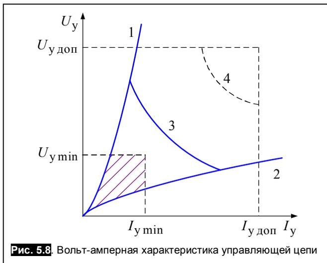
Рис. 5.8. Вольт-амперная характеристика управляющей цепи
