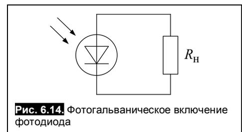
Рис. 6.14. Фотогальваническое включение фотодиода
