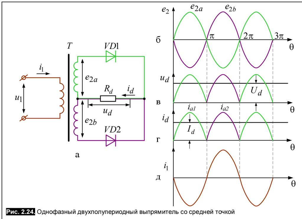
Рис. 2.24. Однофазный двухполупериодный выпрямитель со средней точкой
