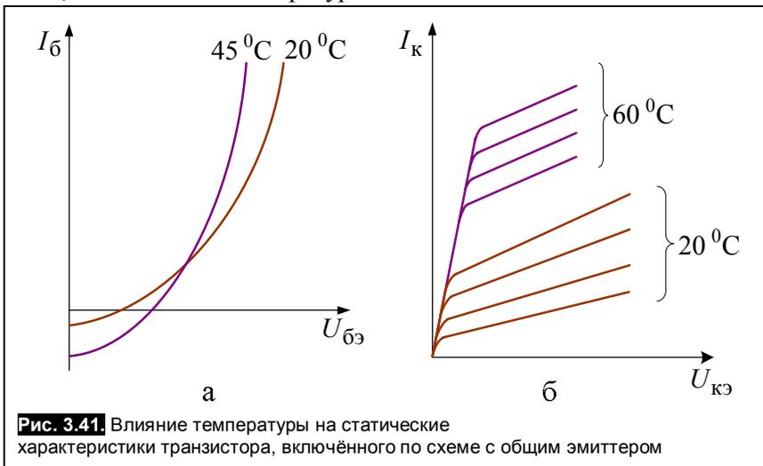
Рис. 3.41. Влияние температуры на статические характеристики транзистора, включённого по схеме с общим эмиттером
