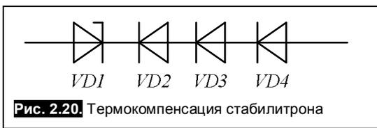
Рис. 2.20. Термокомпенсация стабилитрона
