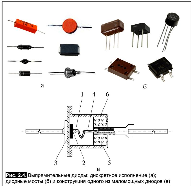
Конструкция ряда маломощных кремниевых диодов практически не отличается от конструкции маломощных германиевых диодов. Кристаллы мощных выпрямительных диодов монтируются в массивном корпусе, который имеет стержень с резьбой для крепления диода на охлаждающем (радиаторе) (рис. 2.5), для отвода выделяющегося при работе прибора тепла.
