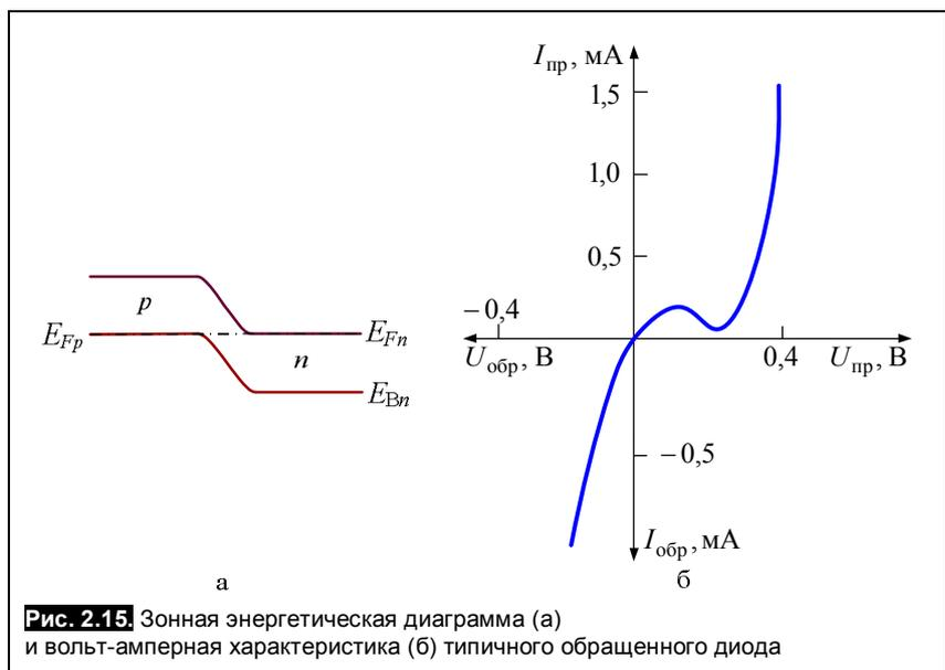
Рис. 2.15. Зонная энергетическая диаграмма (а) и вольт-амперная характеристика (б) типичного обращенного диода
