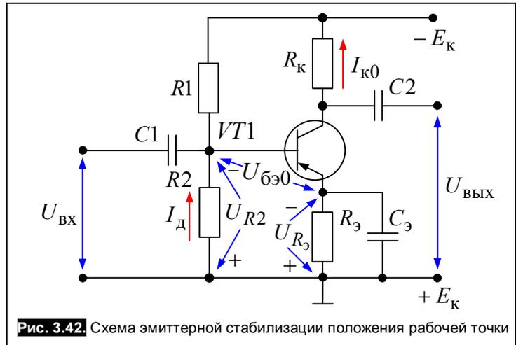
Рис. 3.42. Схема эмиттерной стабилизации положения рабочей точки
