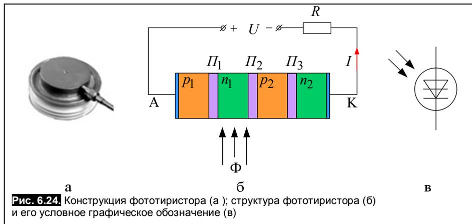
**Рис. 6.24.** Конструкция фототиристора (а); структура фототиристора (б) и его условное графическое обозначение (в)
