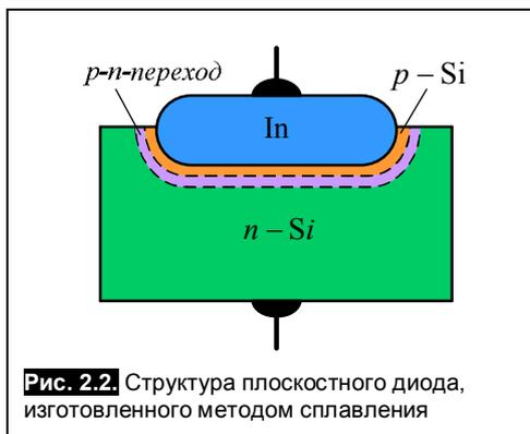
**Рис. 2.2.** Структура плоскостного диода, изготовленного методом сплавления
