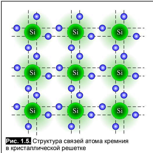
При температуре абсолютного нуля ( $T = 0^0 K$ ) все энергетические состояния внутренних зон и валентная зона занята электронами полностью, а зона проводимости совершенно пуста. Поэтому в этих условиях кристалл полупроводника является практически диэлектриком.
