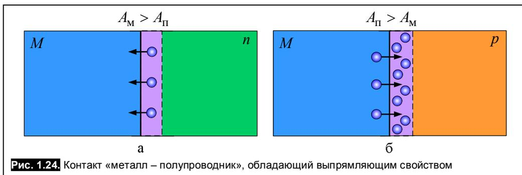
Рис. 1.24. Контакт «металл – полупроводник», обладающий выпрямляющим свойством
