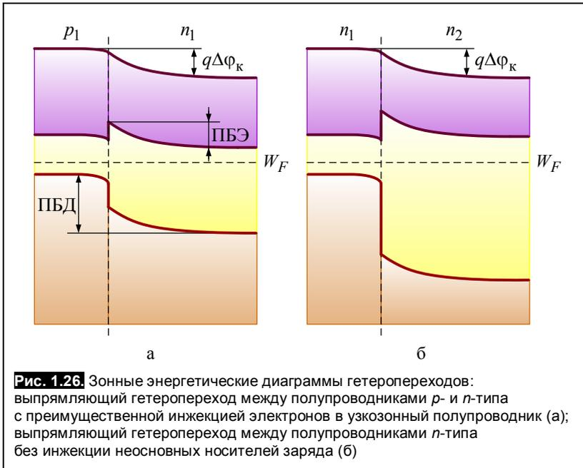
Ширина энергетических зон различных полупроводников различна. Поэтому на границе раздела двух полупроводников получается обычно разрыв дна проводимости. Разрыв дна зоны проводимости определяется различием энергий сродства к электрону двух контактирующих полупроводников (*энергия сродства к электрону* – разница энергий потолка верхней свободной зоны и дна проводимости).
