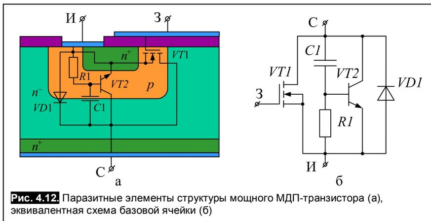
Рис. 4.12. Паразитные элементы структуры мощного МДП-транзистора (а), эквивалентная схема базовой ячейки (б)
