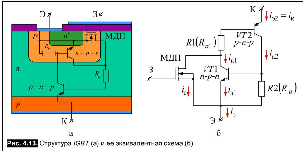
Рис. 4.13. Структура IGBT (а) и ее эквивалентная схема (б)
