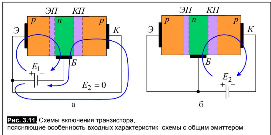
Рис. 3.11. Схемы включения транзистора, поясняющие особенность входных характеристик схемы с общим эмиттером
