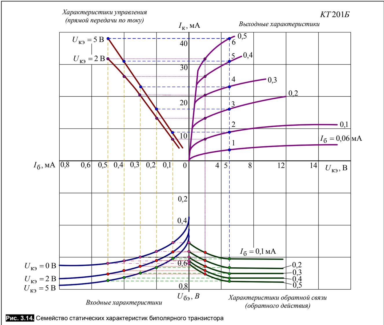
Рис. 3.14. Семейство статических характеристик биполярного транзистора
