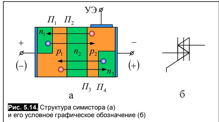
Рис. 5.14. Структура симистора (а) и его условное графическое обозначение (б)
