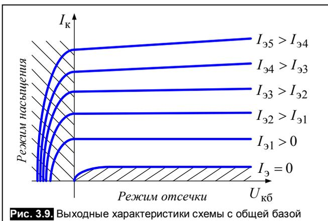
Рис. 3.9. Выходные характеристики схемы с общей базой
