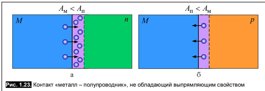
Рис. 1.23. Контакт «металл – полупроводник», не обладающий выпрямляющим свойством
