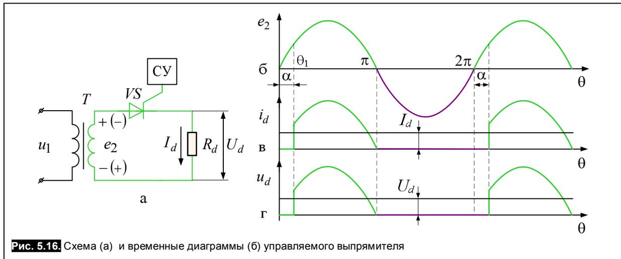
Рис. 5.16. Схема (а) и временные диаграммы (б) управляемого выпрямителя
