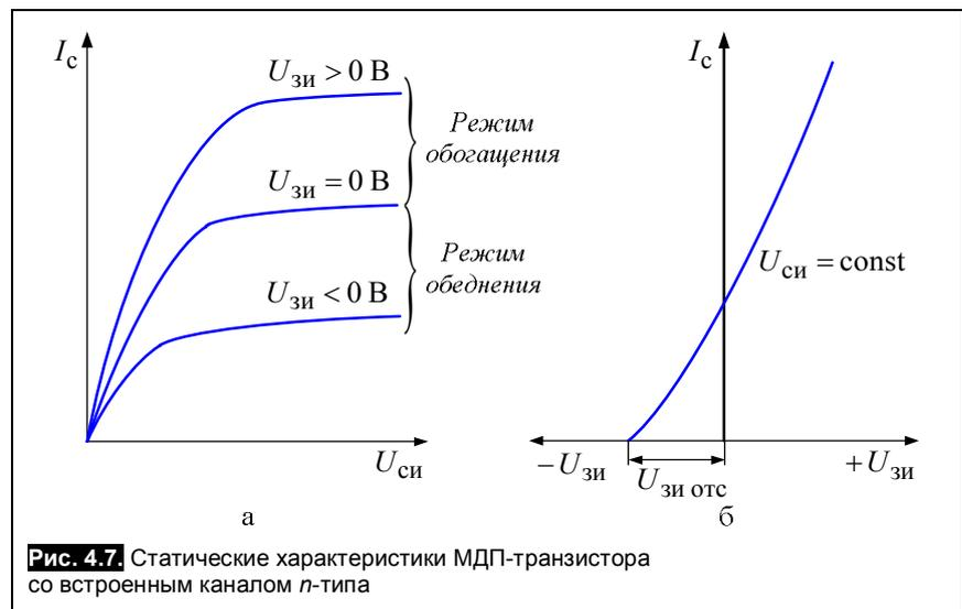
**Рис. 4.7.** Статические характеристики МДП-транзистора со встроенным каналом  $n$ -типа
