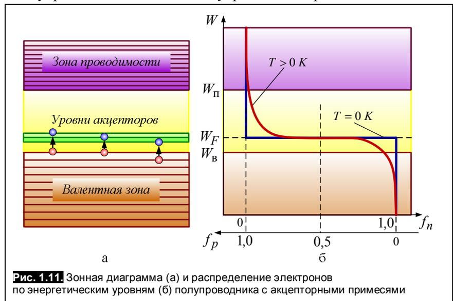
Рис. 1.11. Зонная диаграмма (а) и распределение электронов по энергетическим уровням (б) полупроводника с акцепторными примесями
