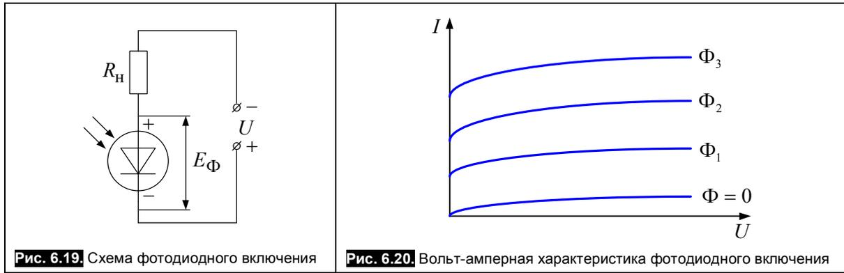
Рис. 6.19. Схема фотодиодного включения
