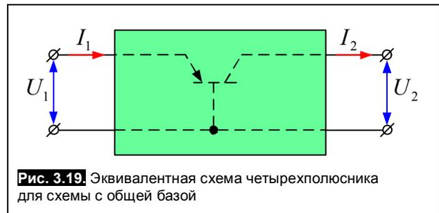
Рис. 3.19. Эквивалентная схема четырехполюсника для схемы с общей базой
