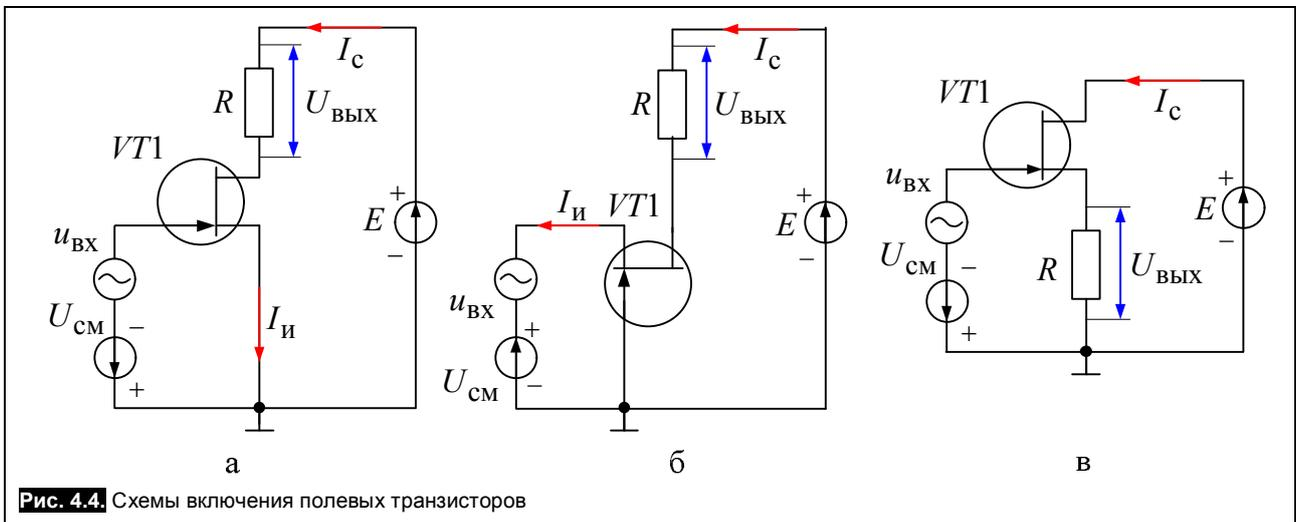
**Рис. 4.4.** Схемы включения полевых транзисторов
