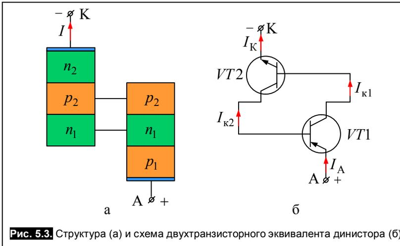
Рис. 5.3. Структура (а) и схема двухтранзисторного эквивалента динистора (б)
