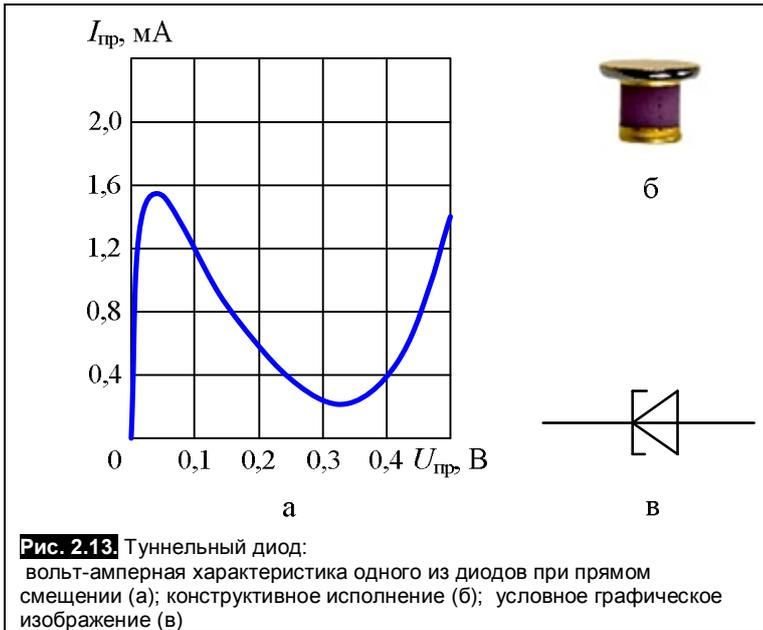
3. Отношение токов  $\frac{I_{\text{п}}}{I_{\text{в}}}$  (для туннельных диодов из GaAs отношение  $\frac{I_{\text{п}}}{I_{\text{в}}} \geq 10$ , для германиевых  $\frac{I_{\text{п}}}{I_{\text{в}}} \approx 3 \dots 6$ );
