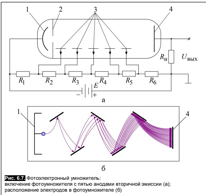
Рис. 6.7. Фотоэлектронный умножитель: включение фотоумножителя с пятью анодами вторичной эмиссии (а); расположение электродов в фотоумножителе (б)
