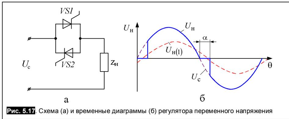
Рис. 5.17. Схема (а) и временные диаграммы (б) регулятора переменного напряжения
