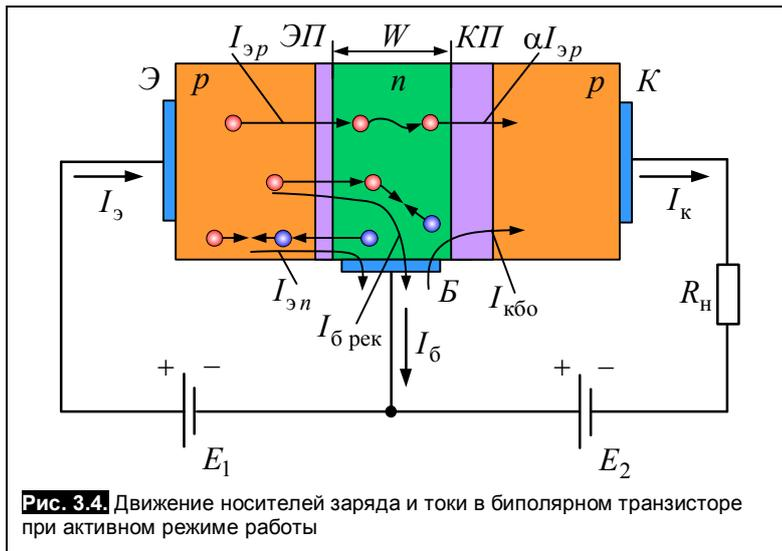
Рис. 3.4. Движение носителей заряда и токи в биполярном транзисторе при активном режиме работы
