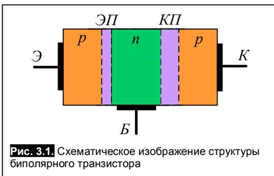
Среднюю область транзистора, расположенную между электронно-дырочными переходами, называют базой (Б). Примыкающие к базе области обычно делают неодинаковыми. Одну из областей делают так, чтобы из неё наиболее эффективно проходила инжекция носителей заряда в базу, а другую – так, чтобы  $p-n$ -переход между базой и этой областью наилучшим образом собирал инжектированные в базу носители заряда, то есть осуществлял экстракцию носителей заряда из базы.
