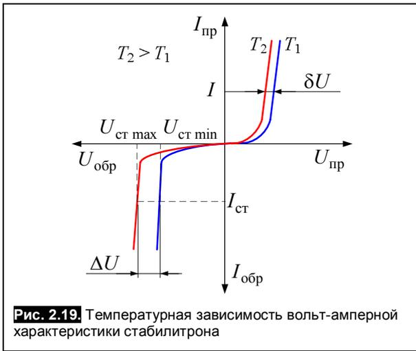
Рис. 2.19. Температурная зависимость вольт-амперной характеристики стабилитрона
