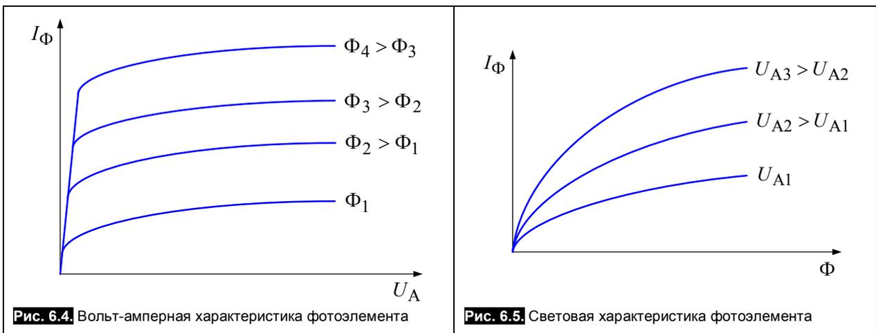
Рис. 6.4. Вольт-амперная характеристика фотоэлемента
