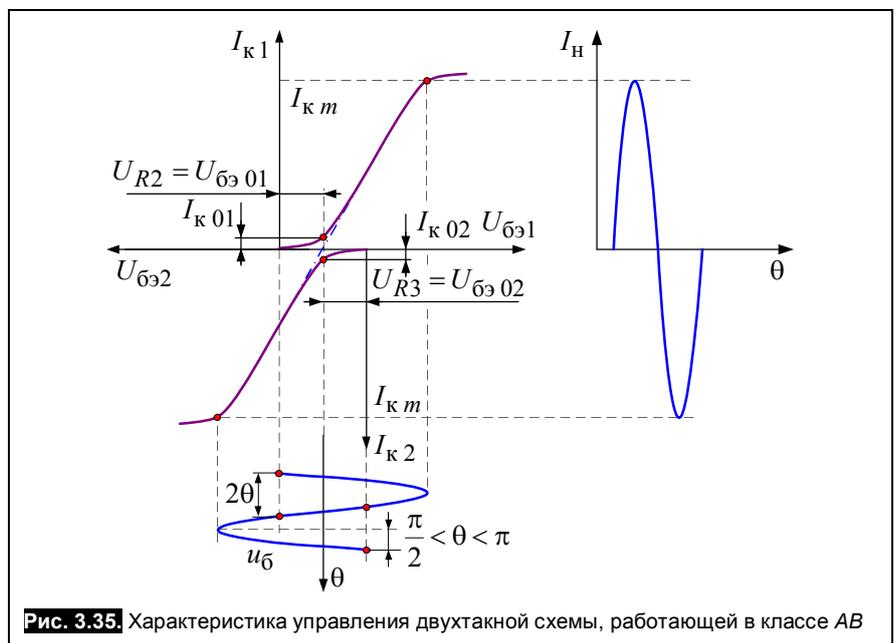
Рис. 3.35. Характеристика управления двухтактной схемы, работающей в классе  $AB$
