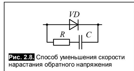
Рис. 2.8. Способ уменьшения скорости нарастания обратного напряжения
