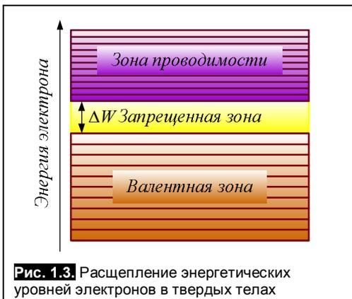
Рис. 1.3. Расщепление энергетических уровней электронов в твердых телах
