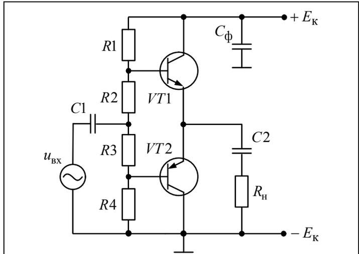
Рис. 3.34. Двухтактная схема класса  $AB$  с делителем напряжения
