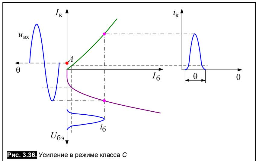
Рис. 3.36. Усиление в режиме класса  $C$
