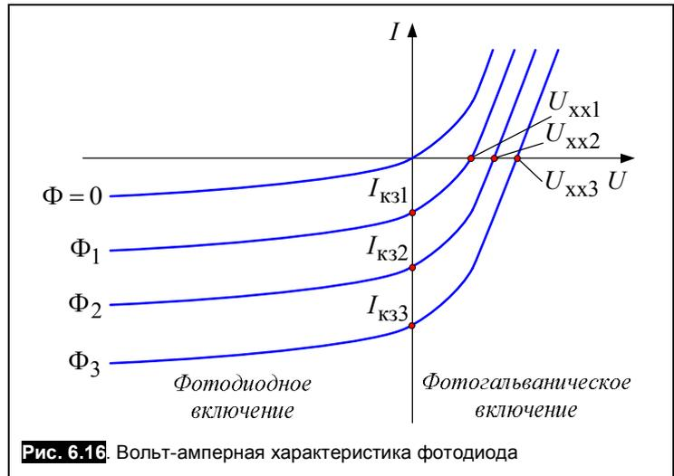
Рис. 6.16. Вольт-амперная характеристика фотодиода
