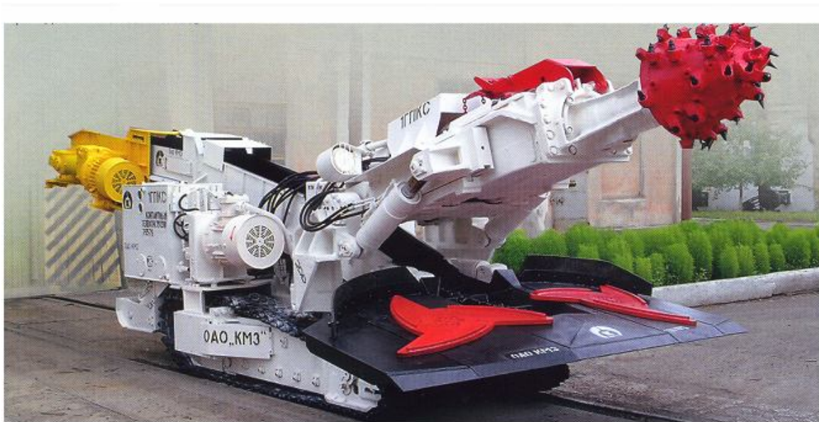
Рис. 4.17. Комбайн проходческий ИГПКС со стреловидным исполнительным органом с продольно-осевой коронкой
