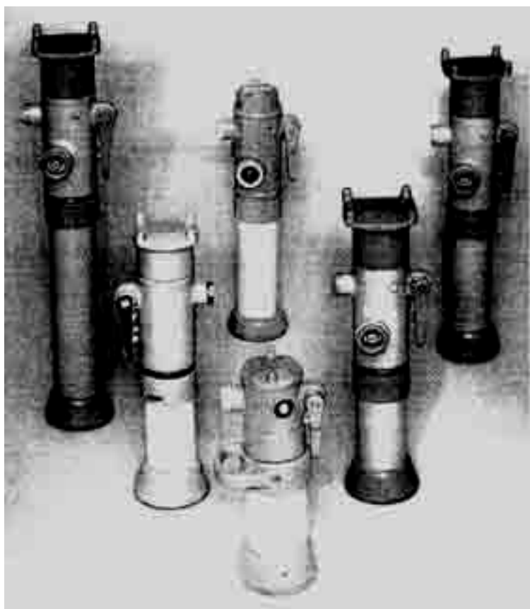
Рис. 2.16. Гидравлические стойки ГСУ
