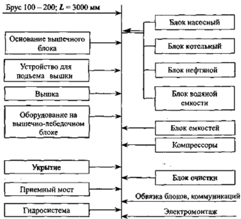
Рис. 164. Схема пооперационной сборки кустовой буровой установки
