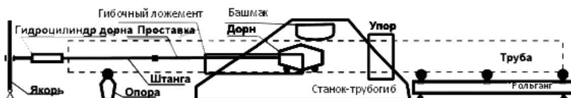
Рис. 5.27. Схема трубогибочного станка
