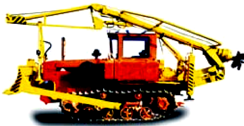
Рис. 15.4. Бурильно-крановая машина БМ-308
