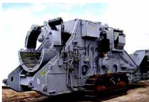
Рис. 5.25. Трубогибочная машина ГТ
