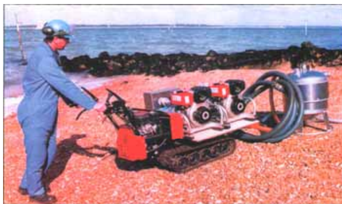
Рис. 16.10. Малогабаритный вакуумный нефтесборщик
