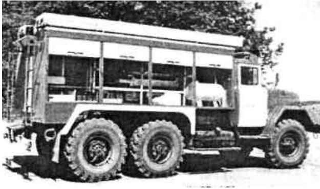
Рис. 19.3. Пожарная автонасосная станция 21352393
