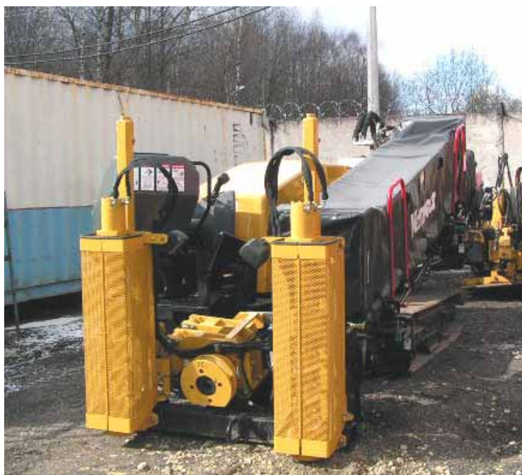
Рис. 7.1. Установка наклонного бурения Vermeer D24 × 40 Series II Navigator
