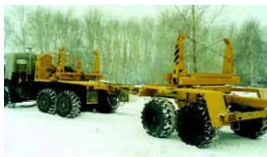
Рис. 3.13. Автопоезд турбовозный электрифицированный 6019
