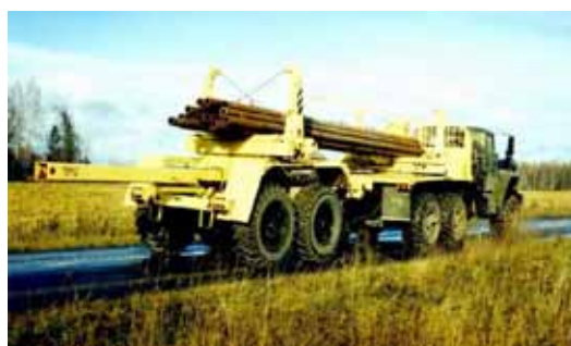
Рис. 3.13. Автопоезд турбовозный электрифицированный 6019
