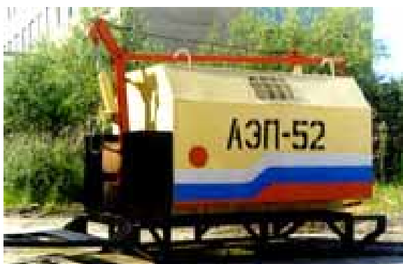
Рис. 20.1. Агрегат электросварочный передвижной АЭП-52
