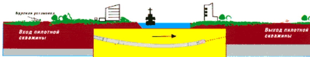
Рис. 7.2. Бурение пилотной (лидерной) скважины
