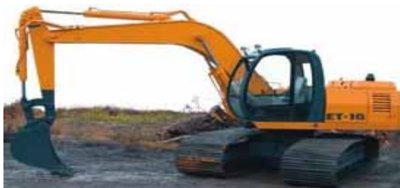
Рис. 4.20. Экскаватор гусеничный гидравлический ET-16
