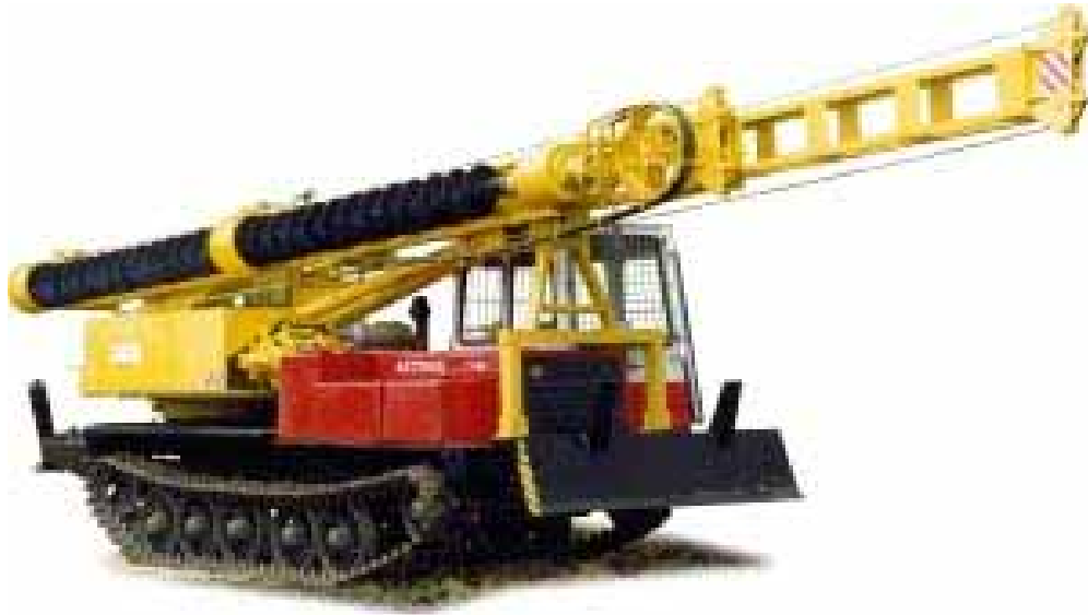
Рис. 15.5. Бурильно-сваебойная машина БМ-831
