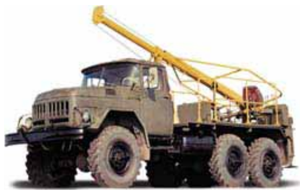
Рис. 15.3. Бурильно-крановая машина БКМ-313
