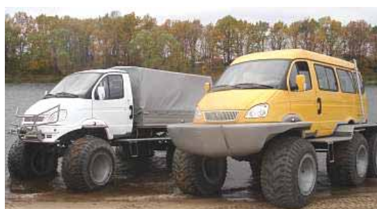
Рис. 3.17. Снегоболотоход на цилиндрических колесах
