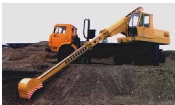
Рис. 4.21. Универсальный экскаватор на шасси автомобиля КАМАЗ
