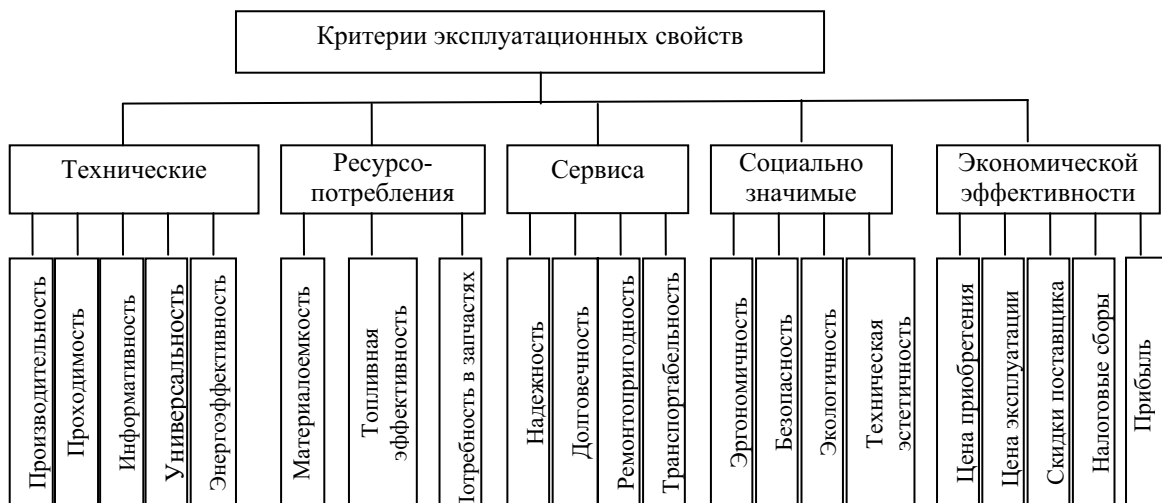
Рис. 1.2. Классификация критериев эксплуатации машин и оборудования для строительства и ремонта магистральных и промысловых трубопроводов
