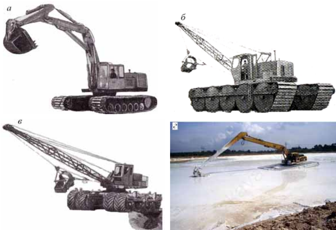
Рис. 8.3. Экскаваторы с сильно развитой опорной поверхностью: а – с резинометаллической гусеницей; б – с уширенной гусеницей и катками-понтонами; в – с пневматическими катками-понтонами; г – плавающий экскаватор с удлиненными стрелой и рукоятью
