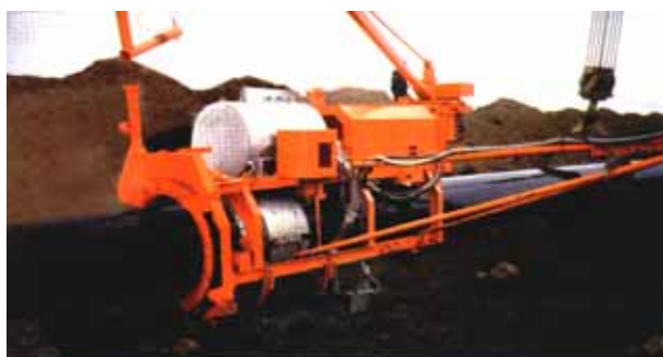
Рис. 6.5. Изоляционная машина типа МИАБ
