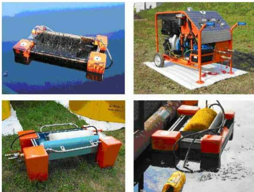
Рис. 16.5. Нефтесборное устройство «Спрут-1»
