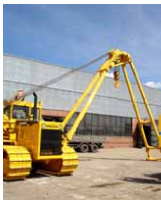
Рис. 5.13. Трубоукладчик с опорой СО-4
