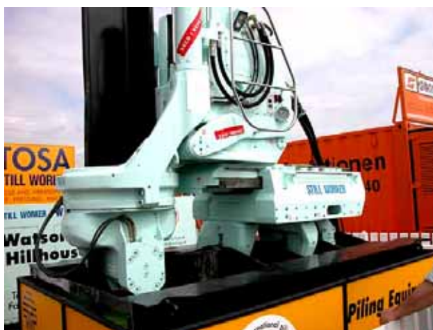
Рис. 15.2. Устройство для выдергивания свай американской фирмы Watson & Hillhouse
