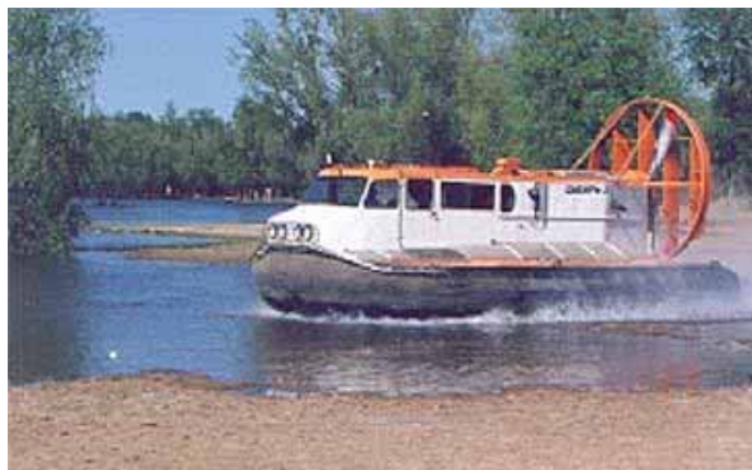
Рис. 3.20. Вездеход на воздушной подушке «Сибирь-2»
