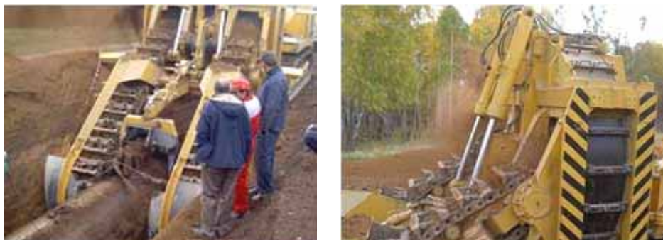
Рис. 4.36. Машина для вскрытия трубопроводов
