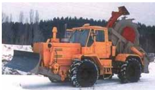
Рис. 4.28. Экскаватор траншейный роторный колесный ЭТР
