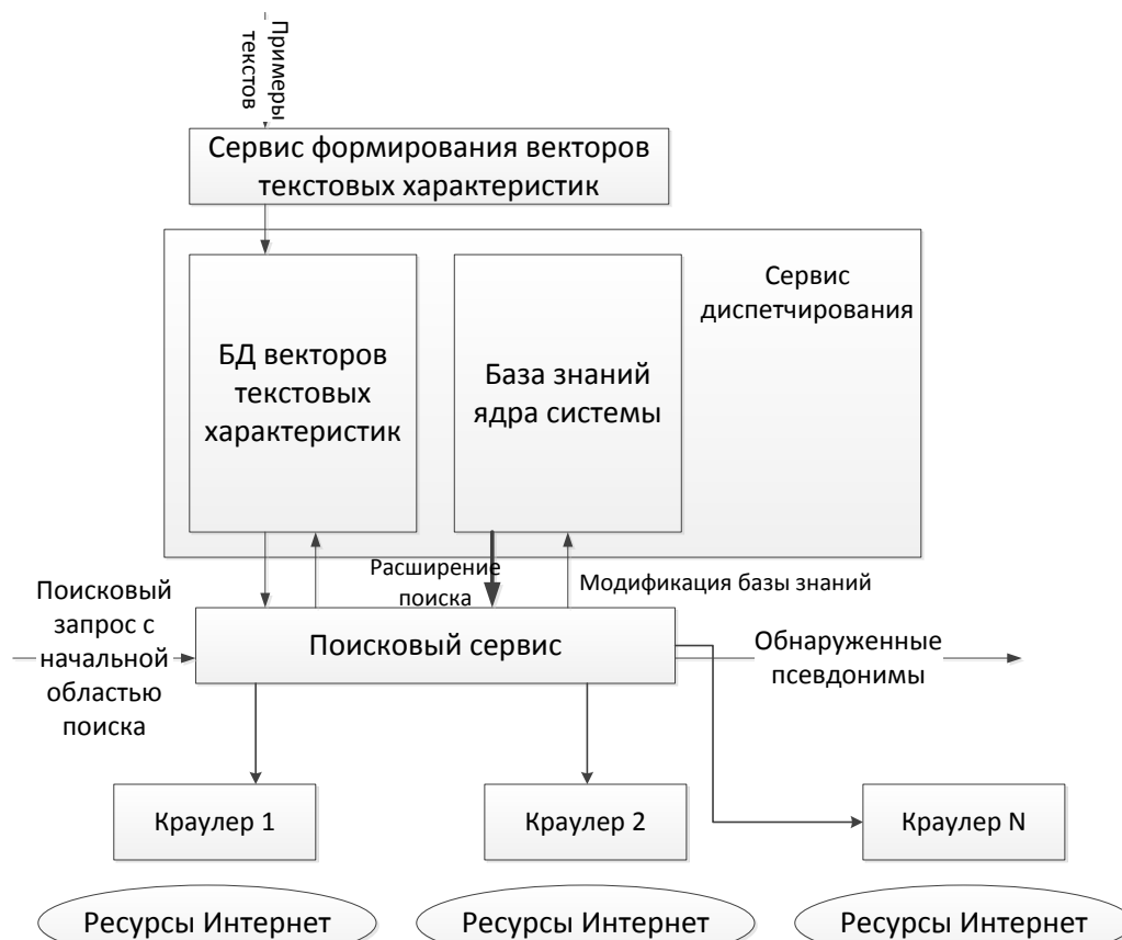
Рисунок 3 – Архитектура когнитивного ассистента как комплексного сервиса
