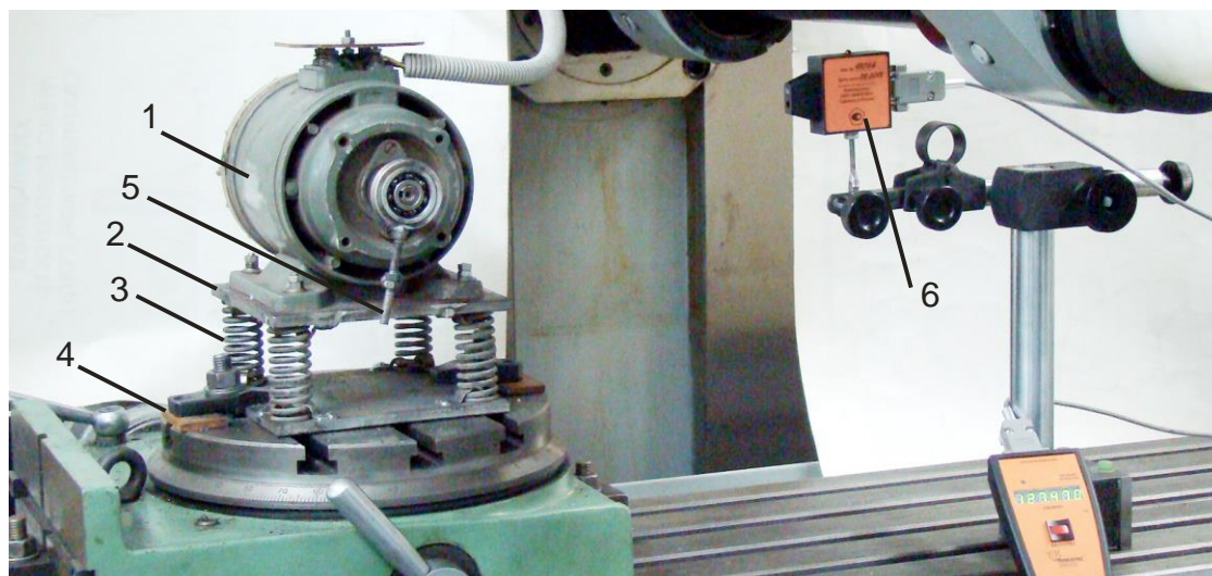
Рис. 1. Экспериментальная установка: 1 – электродвигатель; 2 – металлическая пластина; 3 – пружины; 4 – неподвижное основание; 5 – маятник; 6 – оптический тахометр.
