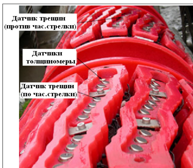
Рис. 5.31. Расположение датчиков на комбинированном ультразвуковом дефектоскопе
