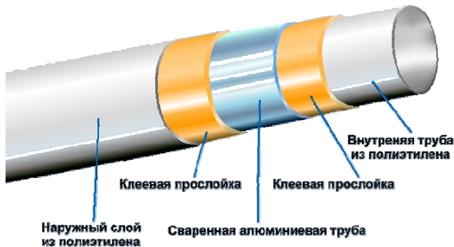
Рис. 5.5. Конструкция многослойной трубы
