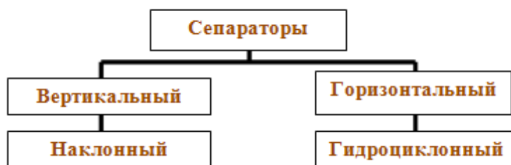
Рис. 3.38. Классификация сепараторов по расположению в пространстве
