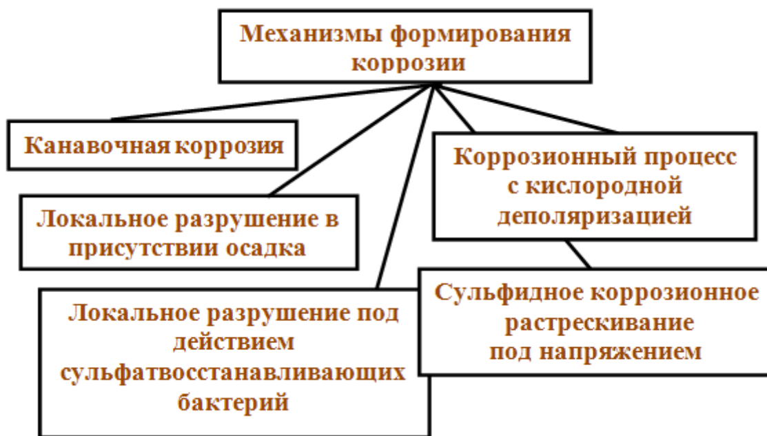
Рис. 4.2. Основные механизмы формирования коррозии
