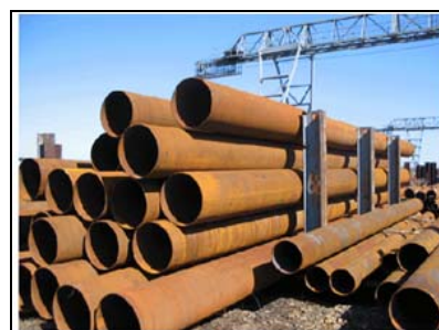
Рис. 1.33. Труба без изоляции
