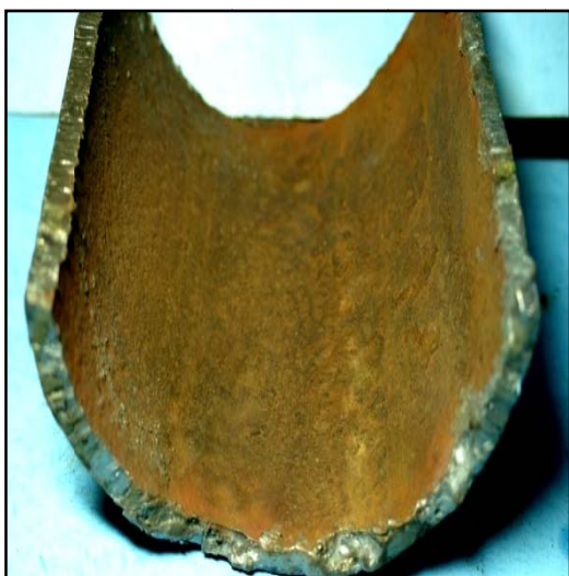
Рис. 4.5. Образование канавочной коррозии промышленного трубопровода ОАО НК «Роснефть-Пурнефтегаз»: Размер труб: \varnothing 159 \times 9,5 мм; марка стали: 10; время эксплуатации до отказа: 14 лет; тип среды: I а, II а
