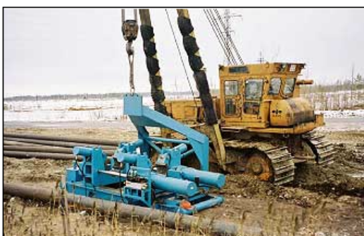
Рис. 2.16. Рабочий агрегат, подвешенный на стрелу трубоукладчика [14]
