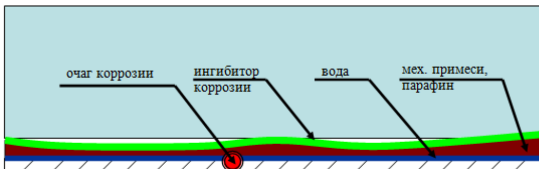
Рис. 5.16. Распределение ингибитора в сечении трубопровода
