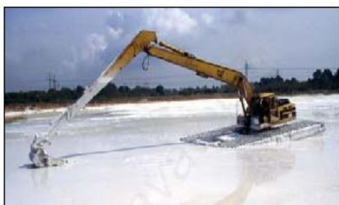
Рис. 1.7. Экскаваторы с сильно развитой опорной поверхностью [6]
