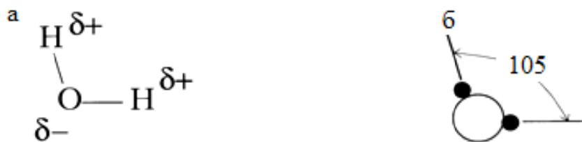
Рис.4.35. Геометрическое строение молекулы воды: линейная схема с указанием наведенных зарядов (а), обуславливающих водородную связь; сферическая модель с указанием угла между атомами водорода (б)
