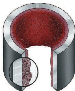
Рис. 4.33. Влияние шероховатости на процесс отложений парафина
