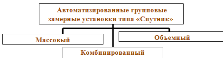
Рис. 3.6. Методы определения дебита скважин
