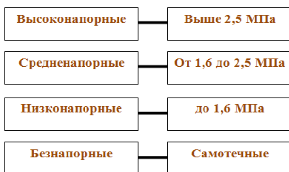
Рис. 1.15. Классификация нефтесборных трубопроводов по величине давления [5]
