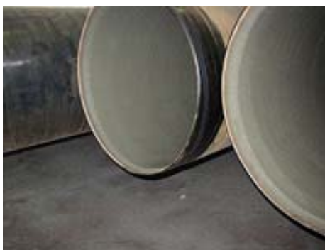
Рис. 5.13. Эпоксидное покрытие труб
