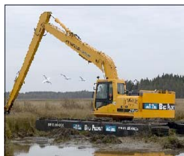
Рис. 1.7. Экскаваторы с сильно развитой опорной поверхностью [6]
