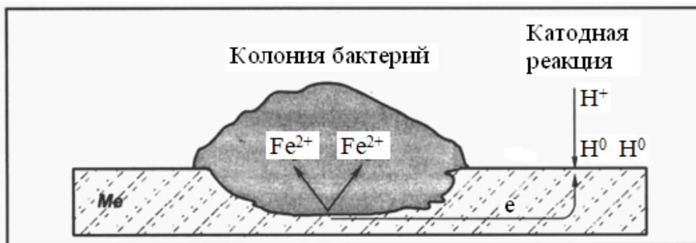
Рис. 4.11. Схематическое изображение роста язв под колонией бактерий
