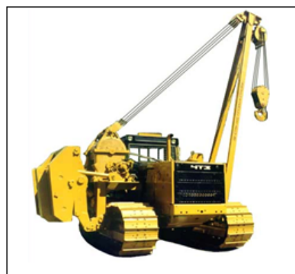
Рис. 1.2. Техника, применяемая при строительстве промышленного трубопровода при подземной прокладке [6]: а) одноковшовый экскаватор; б) роторный траншейный экскаватор с рабочим органом навесного типа; в) бульдозер); г) трубоукладчик
