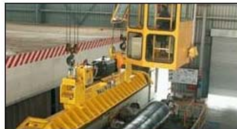
Рис. 2.8. Вакуумные присоски, работа с краном (две подвески) [11]
