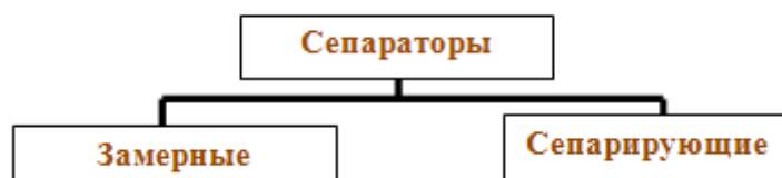
Рис. 3.35. Классификация сепараторов по назначению
