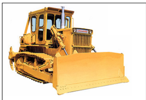
Рис. 1.2. Техника, применяемая при строительстве промышленного трубопровода при подземной прокладке [6]: а) одноковшовый экскаватор; б) роторный траншейный экскаватор с рабочим органом навесного типа; в) бульдозер); г) трубоукладчик
