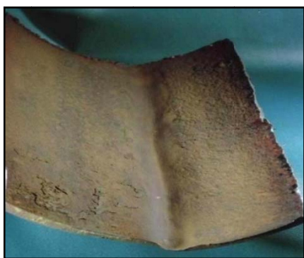
Рис. 4.4. Образование канавочной коррозии низконапорного водовода ОАО «Юганскнефтегаз»:
