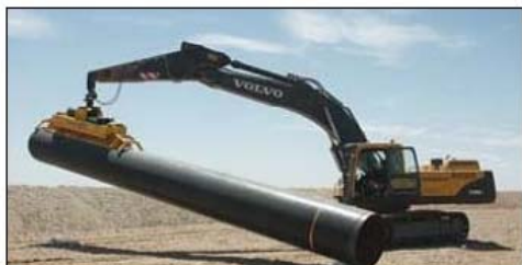
Рис. 2.7. Вакуумные присоски, работа на экскаваторе с гидравлической поворотной стрелой [11]
