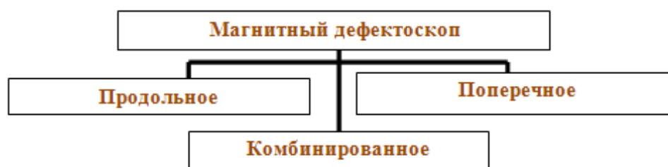
Рис. 5.32. Классификация дефектоскопов по принципу намагничивания
