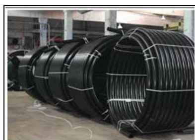
Рис. 1.25. Намотка полиэтиленовой трубы на катушку
