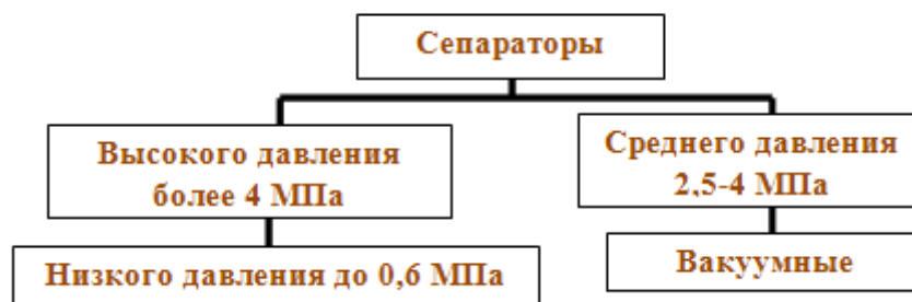
Рис. 3.36. Классификация сепараторов по величине давления
