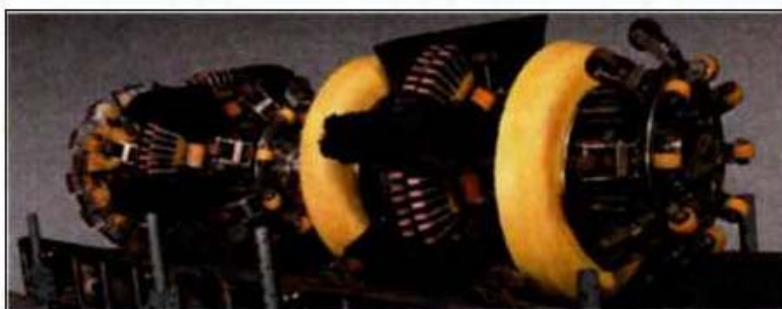
Рис. 5.36. Магнитный дефектоскоп высокого и сверхвысокого разрешения с поперечным намагничиванием (ЗАО «Нефтегазкомплектсервис», г. Москва) [95]
