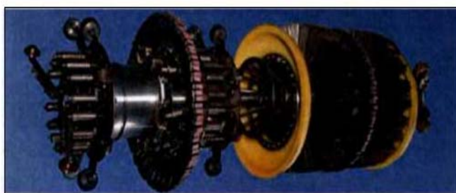
Рис. 5.33. Магнитный дефектоскоп высокого и сверхвысокого разрешения с продольным намагничиванием (ЗАО «Нефтегазкомплектсервис», г.Москва) [95]
