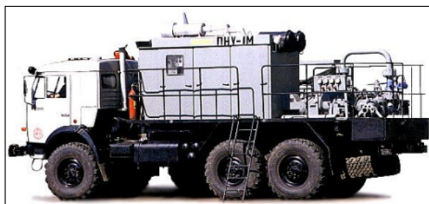
Рис. 2.20. Передвижная насосная установка [16]
