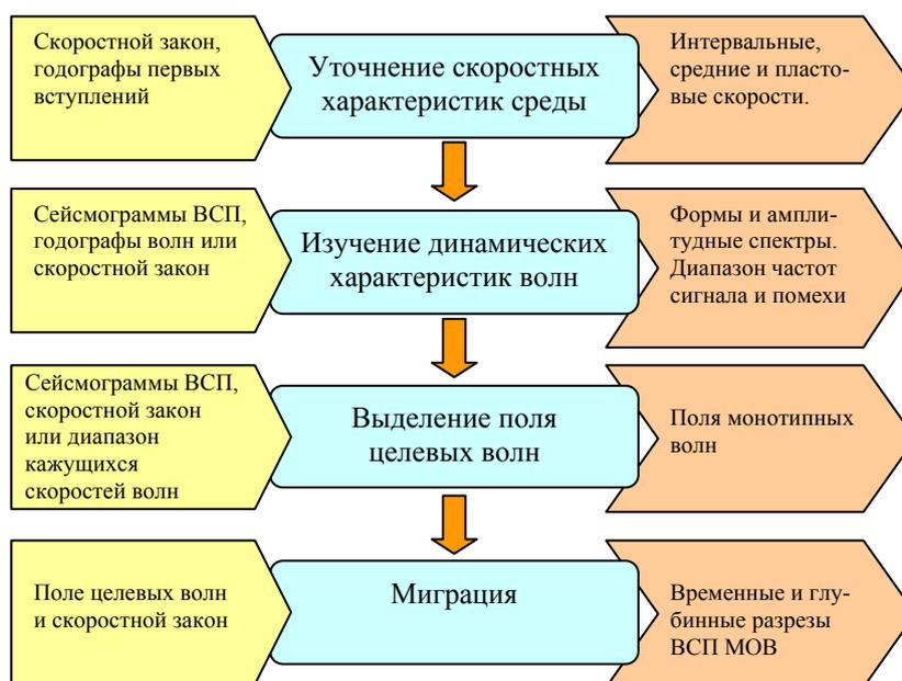
Рис. 3.18. Граф основной обработки непродольного ВСП
