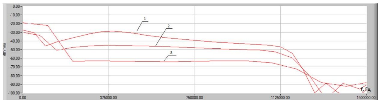
Рис. 2. Спектральная характеристика поглощения сигналов при различной температуре в жидкости (льде), где: 1 – минус 18 °C, 2 – минус 7 °C, 3 – плюс 4 °C. Ось Y – действующее значение напряжения в логарифмической шкале измерения, ось X – частота в герцах
