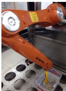
Рис. 2. Проведение эксперимента с помощью автоматизированной ультразвуковой системы томографического контроля
