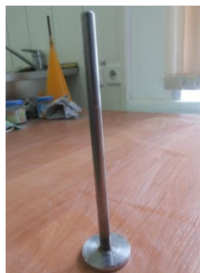
Рисунок 2 – Элемент передачи механической нагрузки на образец
