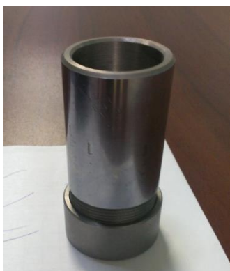
Рисунок 1 – Металлический стакан-зажим образцов резины эластомера
