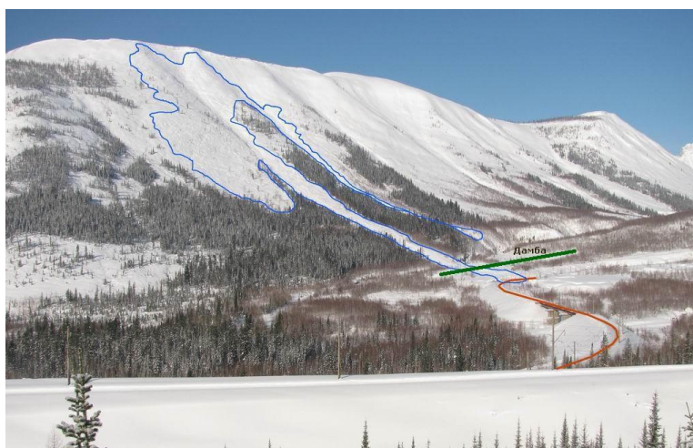
Рисунок 2 . Схема схода лавины с выходом на ж/д пути
