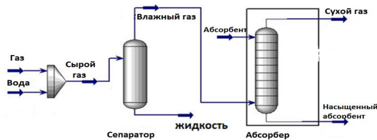
Рис.1. Моделирующая схема абсорбционной осушки газа
