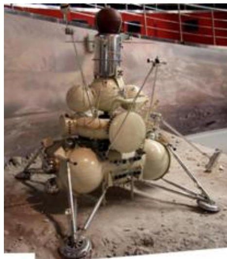
Луноход «ЛУНА- 24» с турбобуром и заборным устройством для отбора лунного грунта
