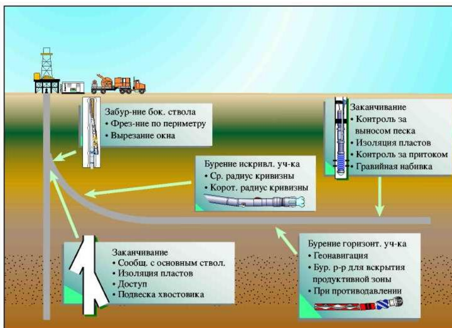
Рис. 1. Система бурения бокового ствола
