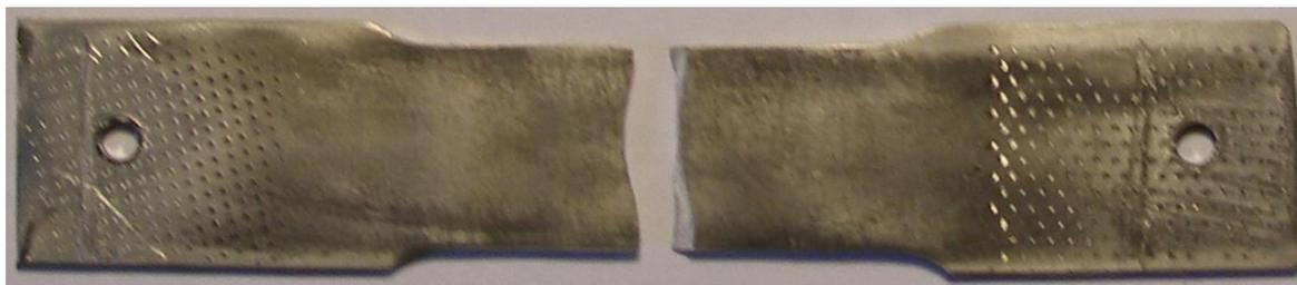
Рис. 1. Образец сплава Ма8-1 с поверхностными структурированными слоями после усталостного разрушения
