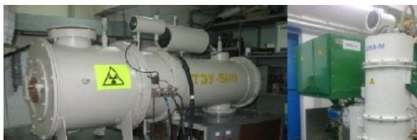
Рисунок 1. Внешний вид ускорителей электронов «ТЭУ» (слева) и «Астра-М» (справа)
