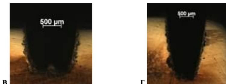
Рисунок 1. Глубина испарения металла в продольном сечении по направлению луча при длительности импульса: а) 30 нс, б) 50 нс, в) 100 нс, г) 200 нс
