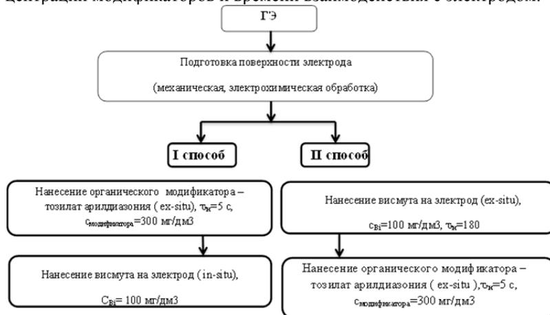
Рис. 2. Схема модифицирования электродов
