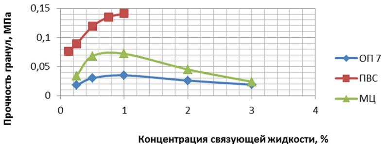
Рис. 3. Зависимость прочности гранул от концентрации связующей жидкости после термообработки при 250 °С
