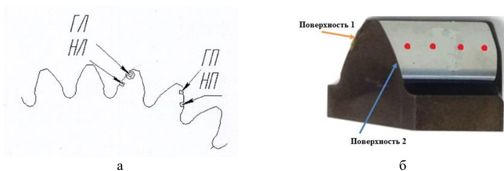
Рисунок 1 – Образцы: а) МД, схема вырезки: ГЛ и НЛ –вырезка образцов из головки ножки зуба на левой поверхности зуба, соответственно; ГП и НП –вырезка образцов из головки ножки зуба на правой поверхности зуба, соответственно; б) контрольные точки измерения ОН методом РД
