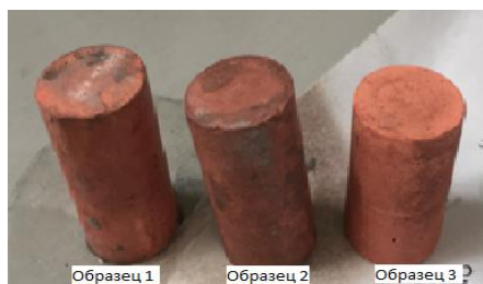
Рисунок 1 – Образцы ЭИ с нанесенным медным покрытием
