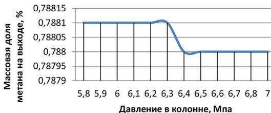
Рис. 4. Зависимость массовой доли метана на выходе от давления в колонне
