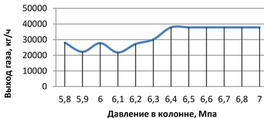
Рис. 3. Зависимость выхода газа от давления в колонне
