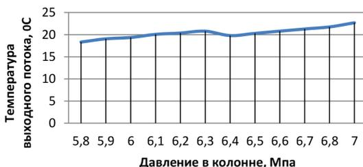
Рис. 2. Зависимость температуры выходного потока газа от давления в абсорбере
