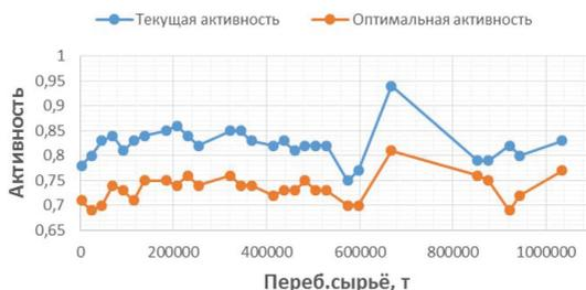
Рис. 1. Сравнение текущей и оптимальной активности катализатора
