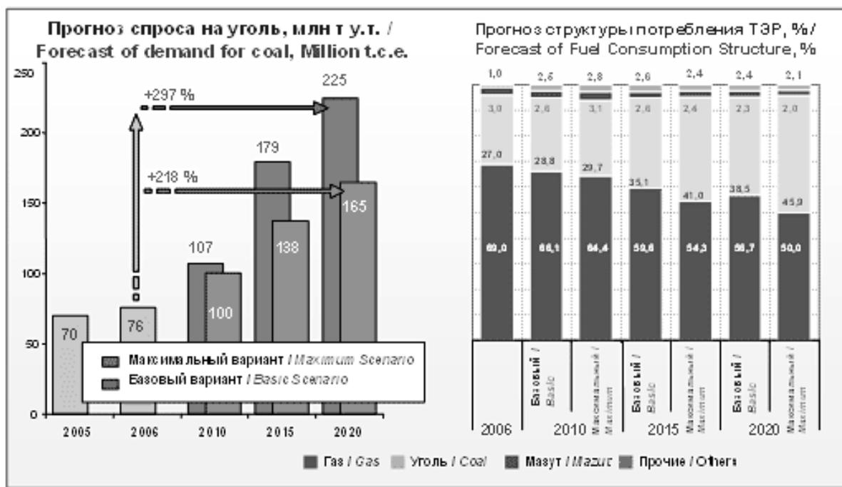
Рисунок 2. Прогноз спроса на энергетический уголь (а) и структура потребления топливно-энергетических ресурсов (ТЭР) теплоэлектростанциями России (б) на период с 2005 по 2020 г. [4]
