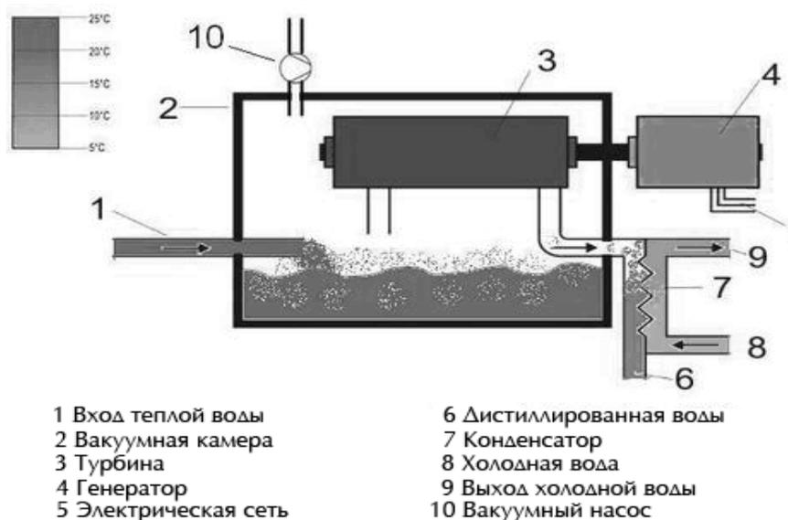
Рисунок 3. ОТЕС с гибридным (открытым) циклом
