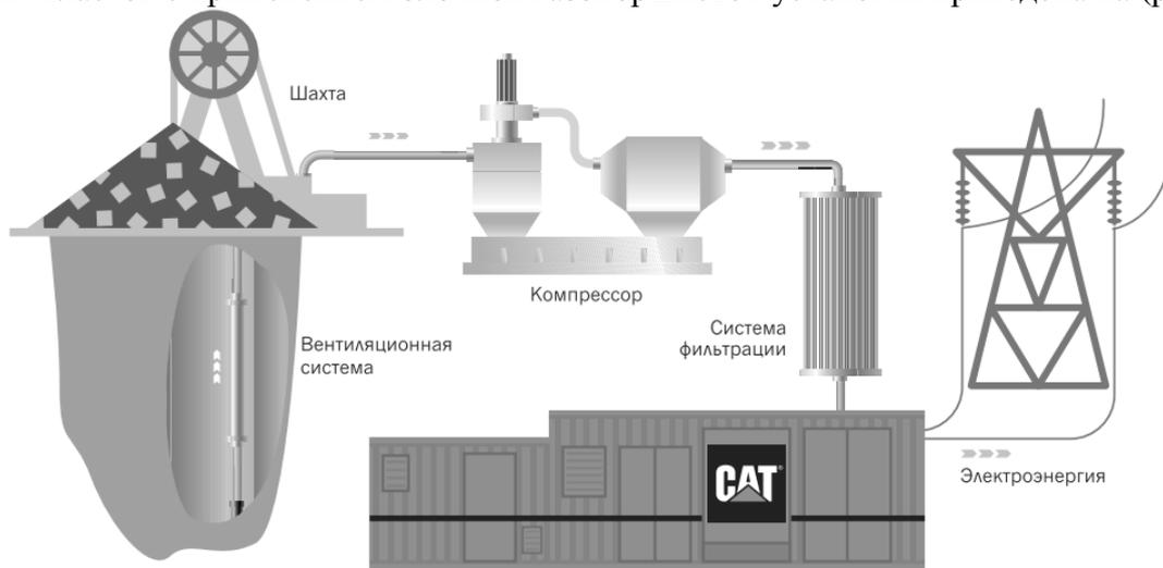
Рисунок 1. Схема использования вентиляционного метана угольных шахт
