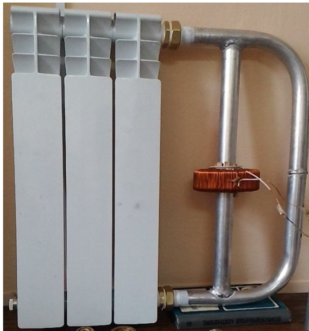
Рис. 3. Сборка трансформаторного нагревателя со стандартным радиатором
