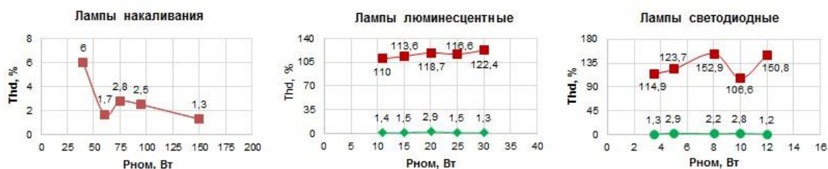
Рис. 5. Суммарный коэффициент гармонических искажений по току (красный) и напряжению (зеленый) за сутки
