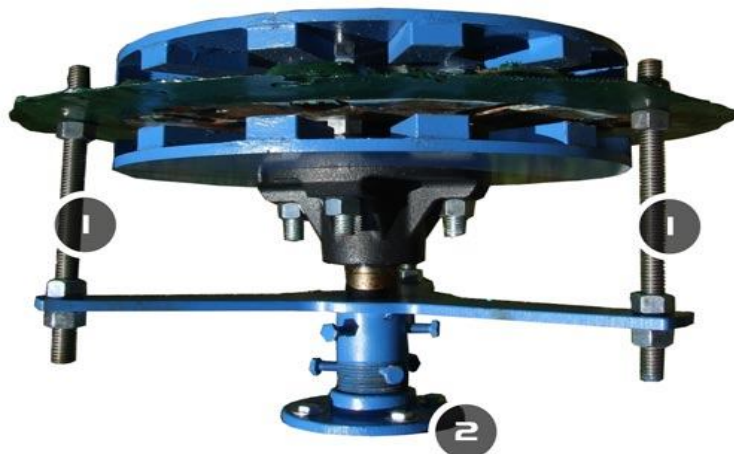
Рис. 2. Генератор с двухслойным ротором с фиксацией статора на внешних шпильках в сборе ( 1- фиксирующие шпильки статора , 2 – основание для крепления статора)
