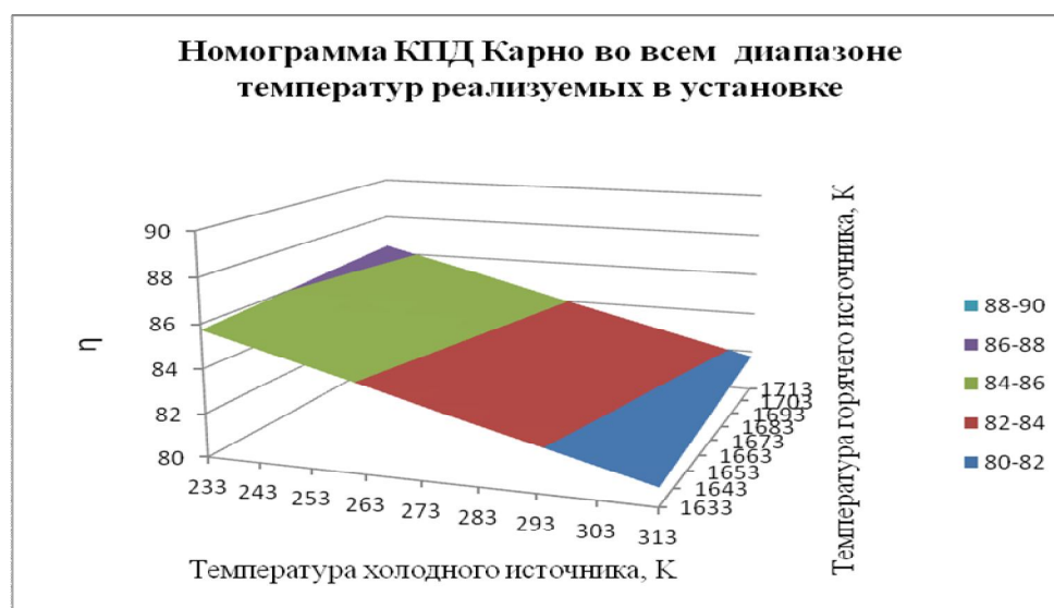
Рис. 3. Номограмма КПД Карно во всем диапазоне температур реализуемых в установке
