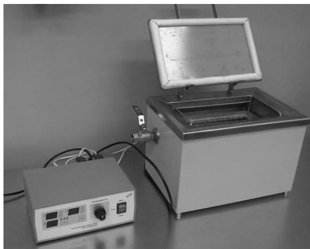
Рис. 4. Внешний вид ультразвуковой ванны и блока управления
