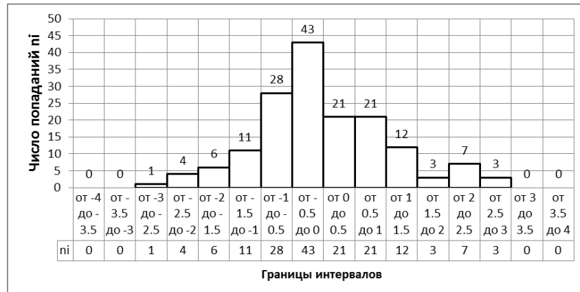
Рис. 3. Гистограмма распределения значений случайной составляющей P_R(t_i) суточного графика нагрузки на интервале 0:00-8:00 час
