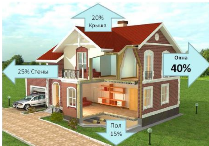
Рис. 1. Тепловые потери через ограждающие конструкции
