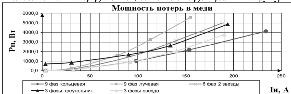
Рис. 3. Зависимости мощности потерь в меди от тока нагрузки различных структур ВГ
