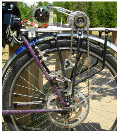
Рис. 4. Пример привода отдельным блоком
