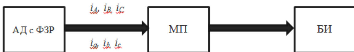
Рис. 1. Блок-схема микропроцессорного устройства для мониторинга АД с ФЗР
