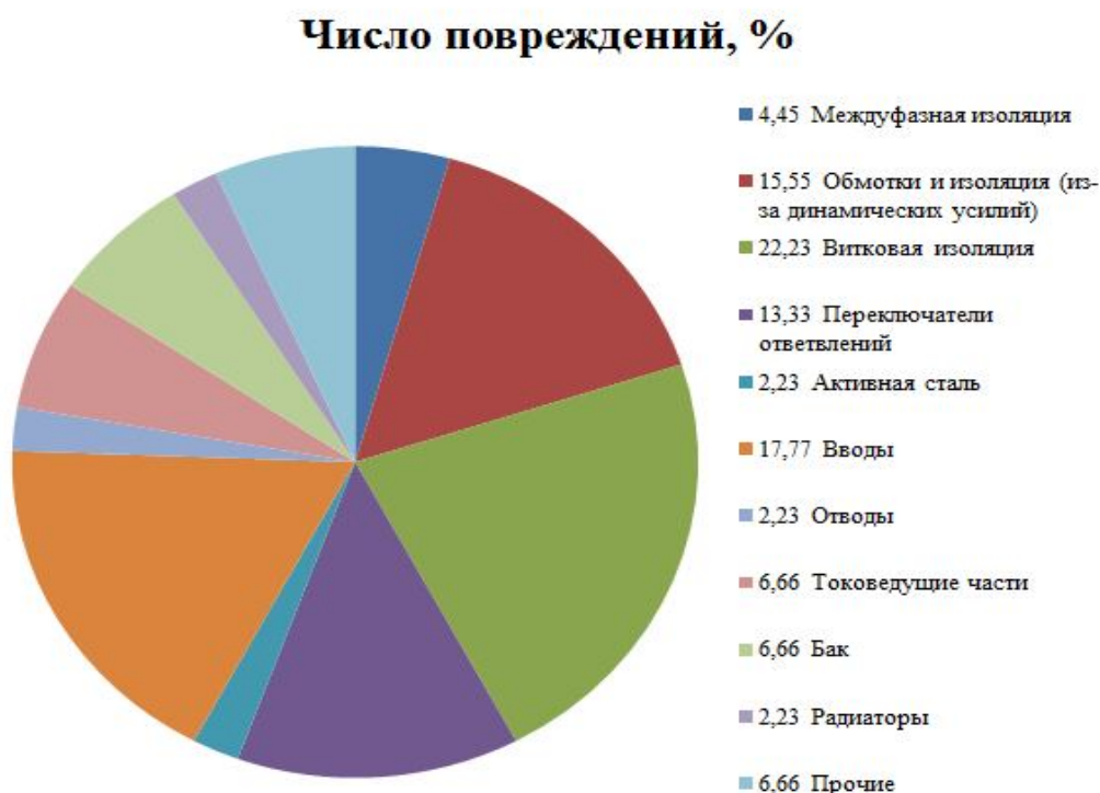
Рис. 1. Наиболее слабые и часто повреждаемые узлы
