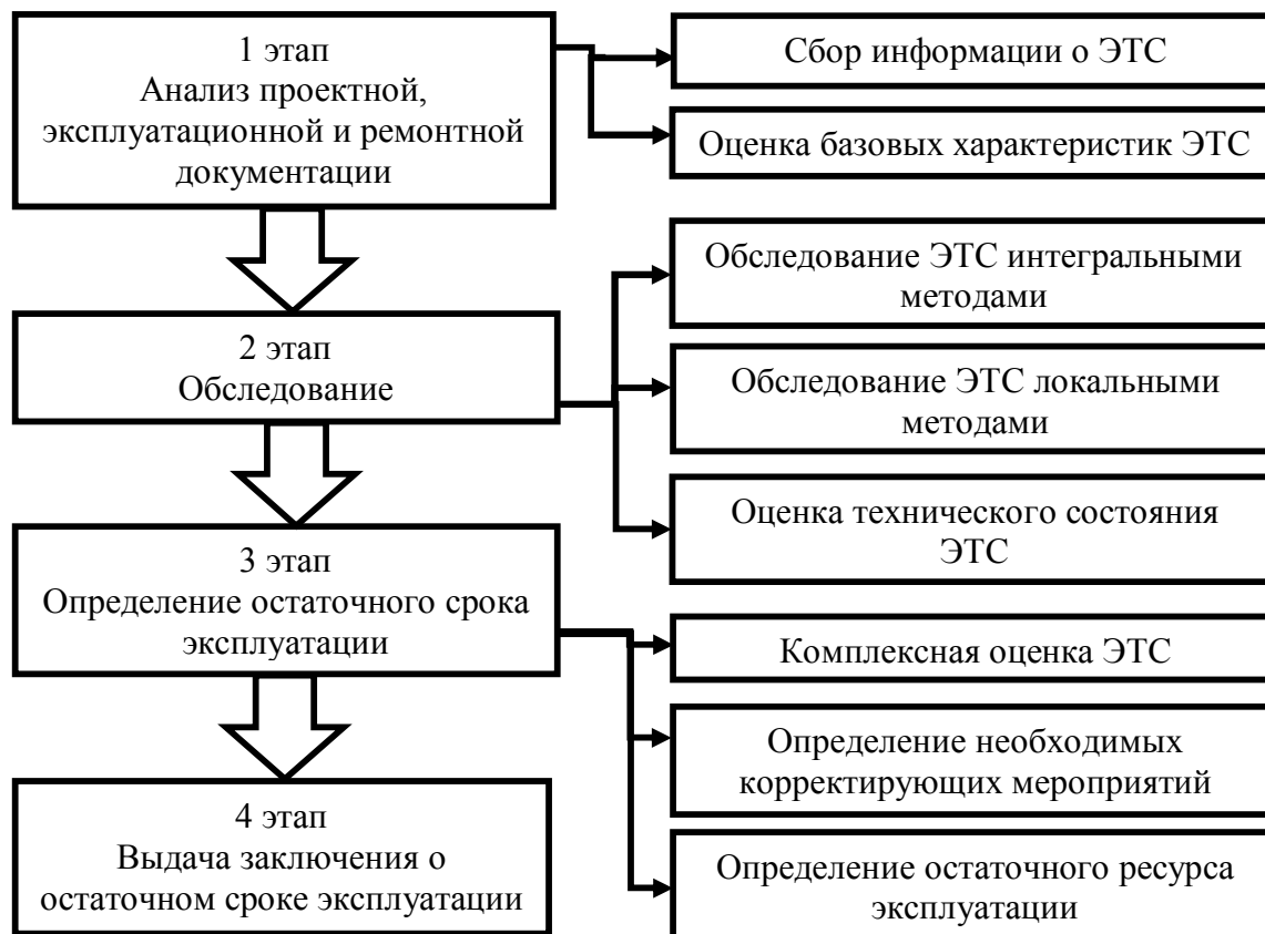
Рис. 1. Алгоритм проведения технического диагностирования ЭТС
