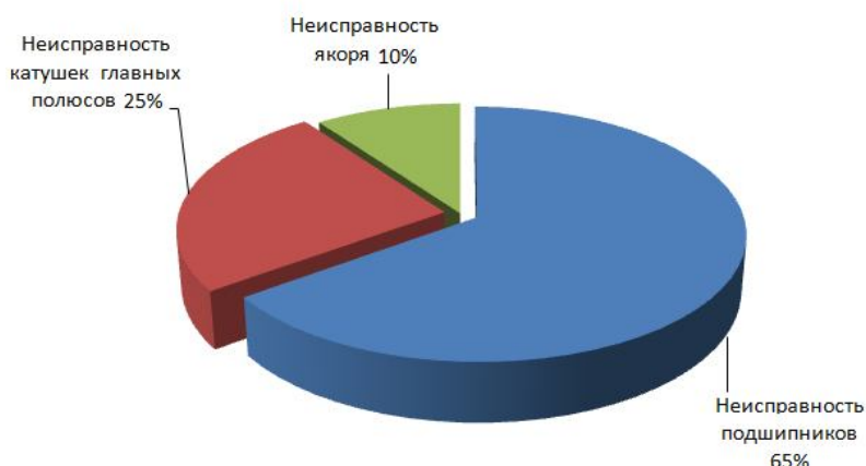
Рис. 3. Отказы основных узлов тягового электродвигателя трамвая 71-619 КТ (КТМ-19) в %
