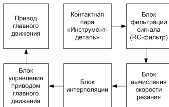
Рис.1. Регистрация и обработка сигнала термоЭДС
