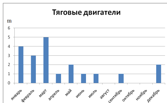
Рис. 2. Динамика выхода из строя тягового электродвигателя в зависимости от времени года
