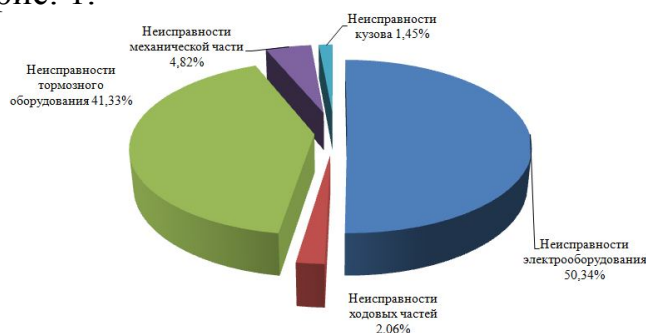
Рис. 1. Отказы основных узлов трамвайного вагона в %
