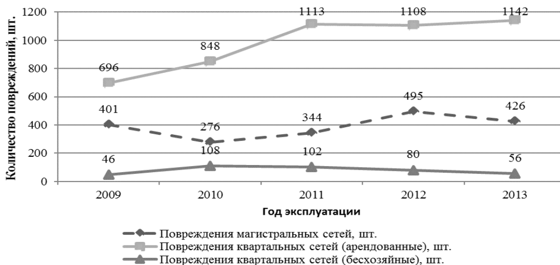
Рис. 2. Анализ повреждаемости ТС с 2009 по 2013 гг.
