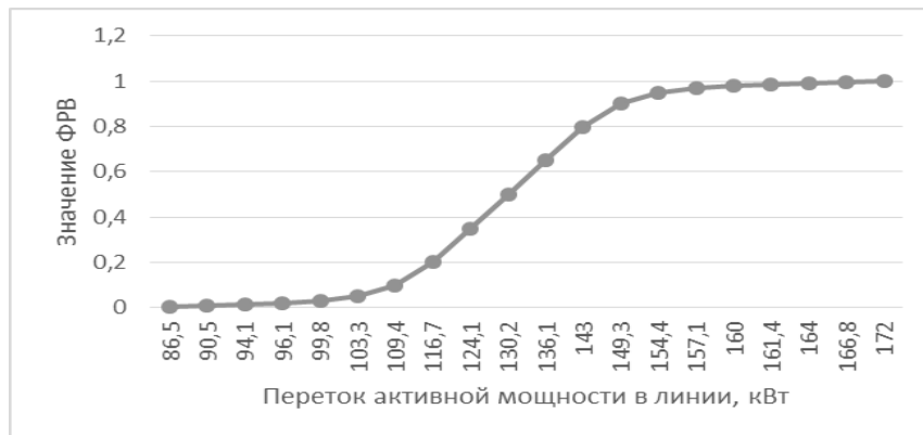
Рис.3. ФРВ перетока активной мощности в линии
