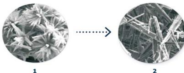
Рисунок 1. Структурная перестройка карбоната кальция в результате МОВ
