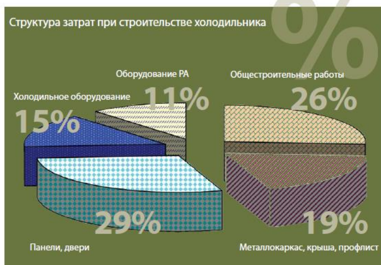
Рис. 3 - Структура затрат при строительстве холодильника
