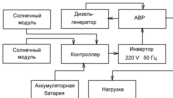
Рис.3. Структурная схема автономной солнечно-дизельной электростанции
