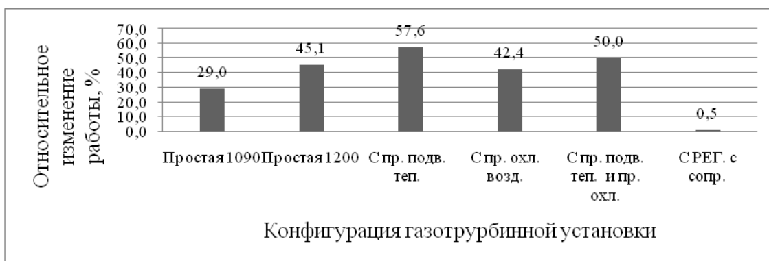
Рис. 1 Зависимость работы на валу агрегата от конфигурации газотурбинной установки
