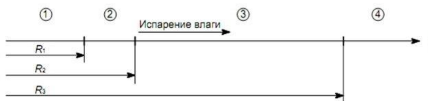
Рис. 1. Схематическое изображение области решения: 1 – теплоноситель; 2 – стенка трубы; 2 – слой увлажненной изоляции; 4 – окружающая среда.
