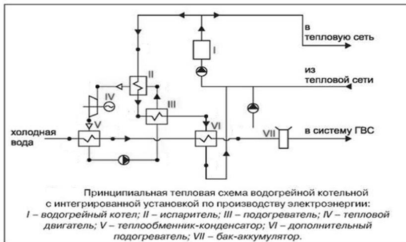
Рис. 2. Принципиальная тепловая схема бутанового контура
