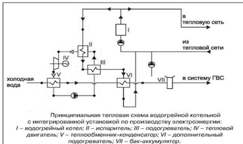
Рис. 2. Принципиальная тепловая схема бутанового контура
