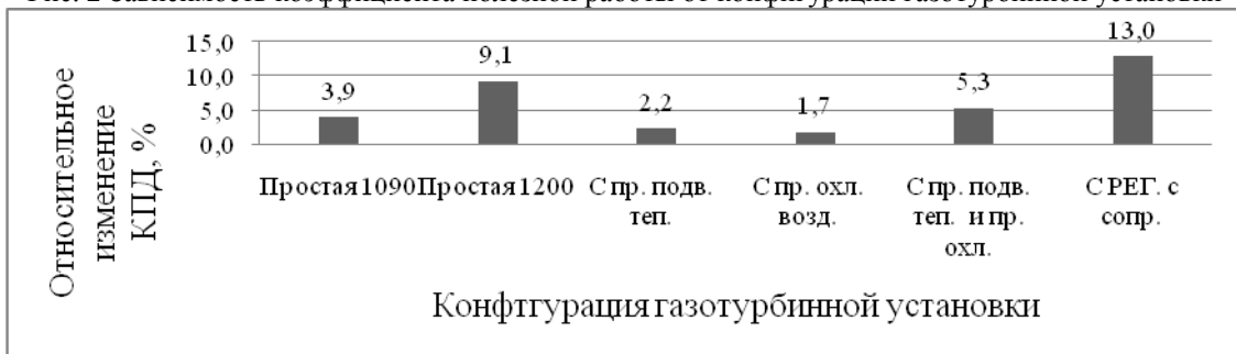
Рис. 3 Зависимость КПД от конфигурации газотурбинной установки
